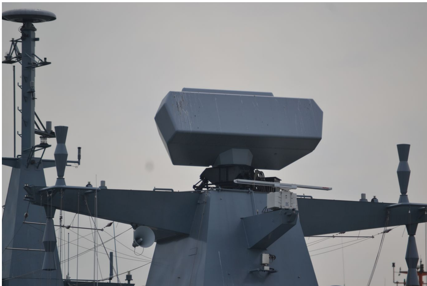
Trójwspółrzędna stacja radiolokacyjna SMART-S Mk2 na „Ślązaku” jest lepsza niż radary AN/SPS-49A(V)1 na fregatach typu Adelaide. Fot. M.Dura
