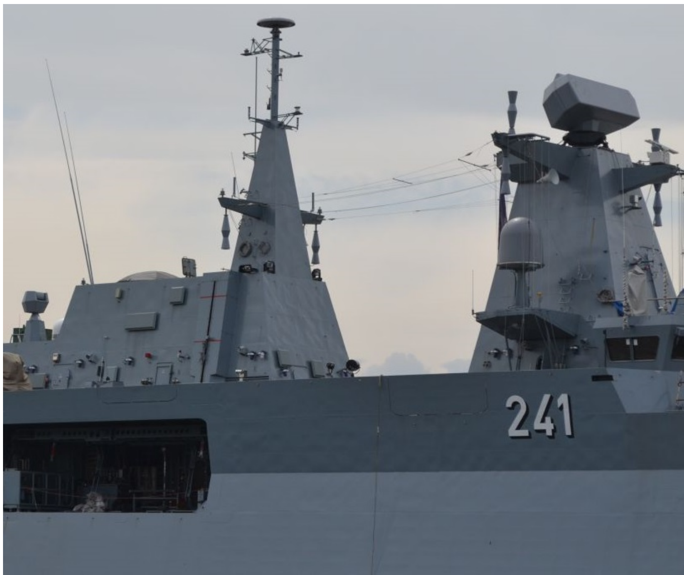
Na patrolowcu „Ślązak” pomiędzy masztami znajduje się miejsce dla rakiet przeciwokrętowych. Fot. M.Dura
