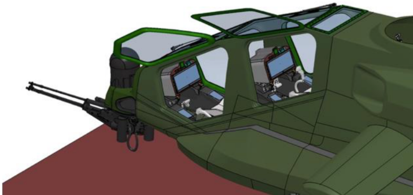
Przednia część kadłuba AH-249. Widać umieszczenie działka 20 mm i głowicy optoelektronicznej oraz układ kabiny z pojedynczym wyświetlaczem dotykowym. Fot. Aviazione Dell 'Esercito
