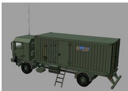
Wóz wskaźnikowy i anteny radaru dalekiego zasięgu P-18PL z anteną AESA na pasmo VHF – fot. PIT-Radwar
