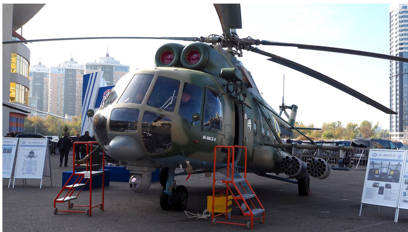
Mi-8MSB-W z podwieszonym uzbrojeniem i głowica optoelektroniczną. Fot. J.Sabak
