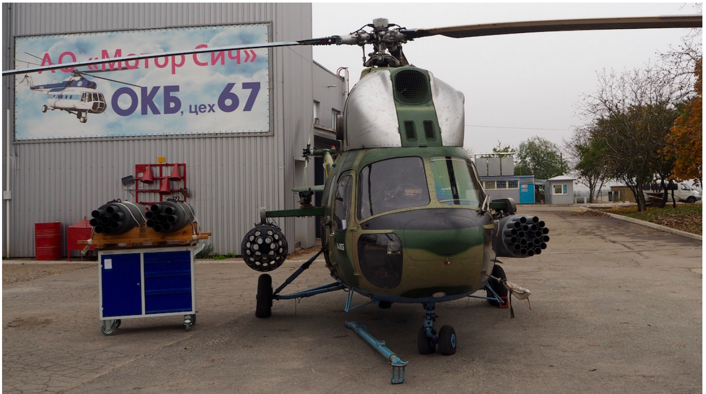
Mi-2MSB-W z podwieszonymi wyrzutniami dwudziestoprowadnicowymi B8W20MSB i dwie wyrzutnie ośmioprowadnicowe B8W8MSB kalibru 80 mm opracowane przez zakłady Motor Sicz. Fot. J.Sabak
