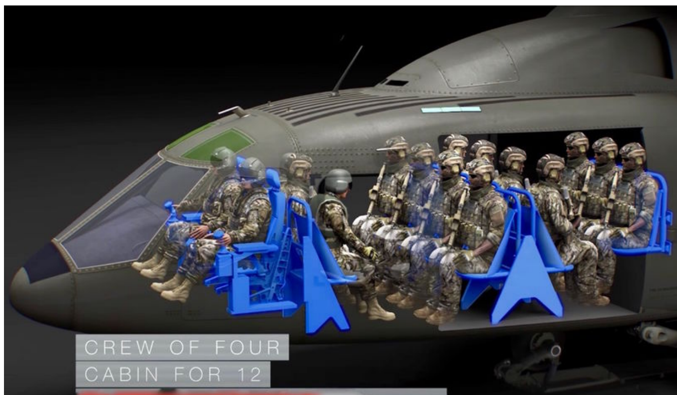
Konfiguracja kabiny SB-1 Defiant w wersji transportowej. Fot. Boeing
