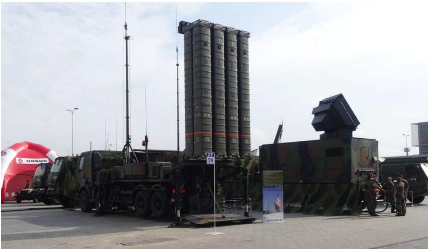
System obrony powietrznej SAMP/T w pozycji "bojowej". Widoczna jest wyrzutnia i stacja radarowa Arabel - fot.
