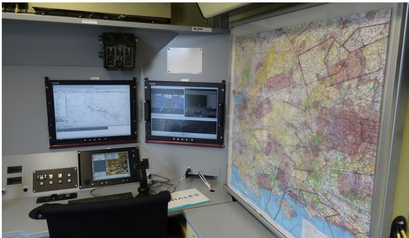
Wnętrze stacji kontrolnej BSL Watchkeeper, prezentowanej w Polsce po raz pierwszy. Na zdjęciu widać jedno stanowisko operatora i mapę nad stołem analityka. - fot. J.Sabak/D24
