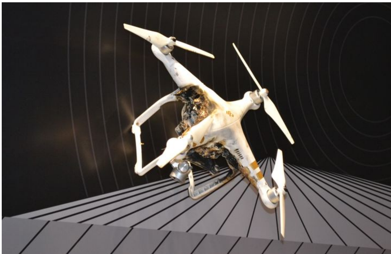
Dron zniszczony przez działko laserowe systemu Drone Dome-L. Fot. M.Dura
