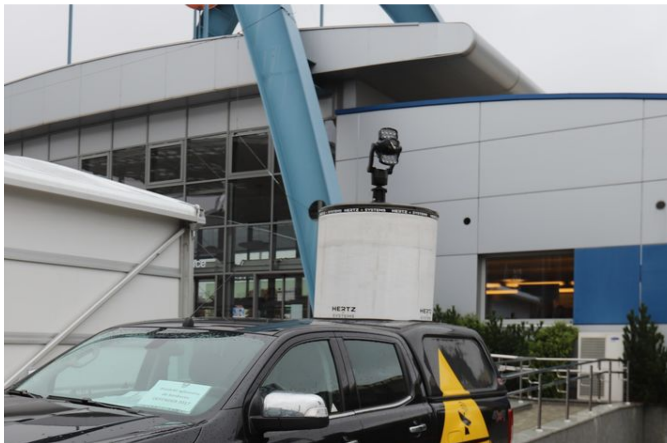
System „Jastrząb” wykorzystuje do wykrywania dronów radar w specjalnej kopule oraz znajdujący się ponad tą kopułą układ kamer. Fot. M.Dura
