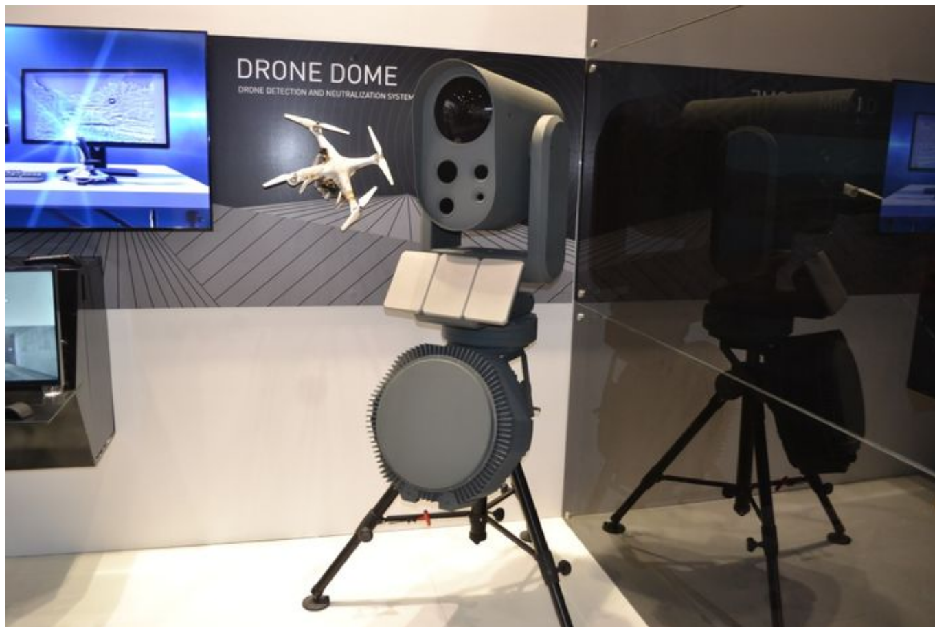
Stacjonarny system przeciwdronowy Drone Dome-L izraelskiego koncernu Rafael wykorzystuje do neutralizacji dronów m.in. działko laserowe. Fot. M.Dura
