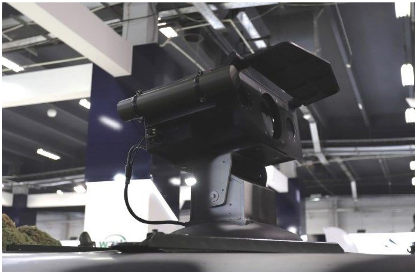
Głowica optoelektroniczna typu 01 system antydronowego ICARX ze zintegrowaną anteną cylindryczną nadajnika zakłóceń Lancy Elektromagnetycznej. Fot. M.Dura
