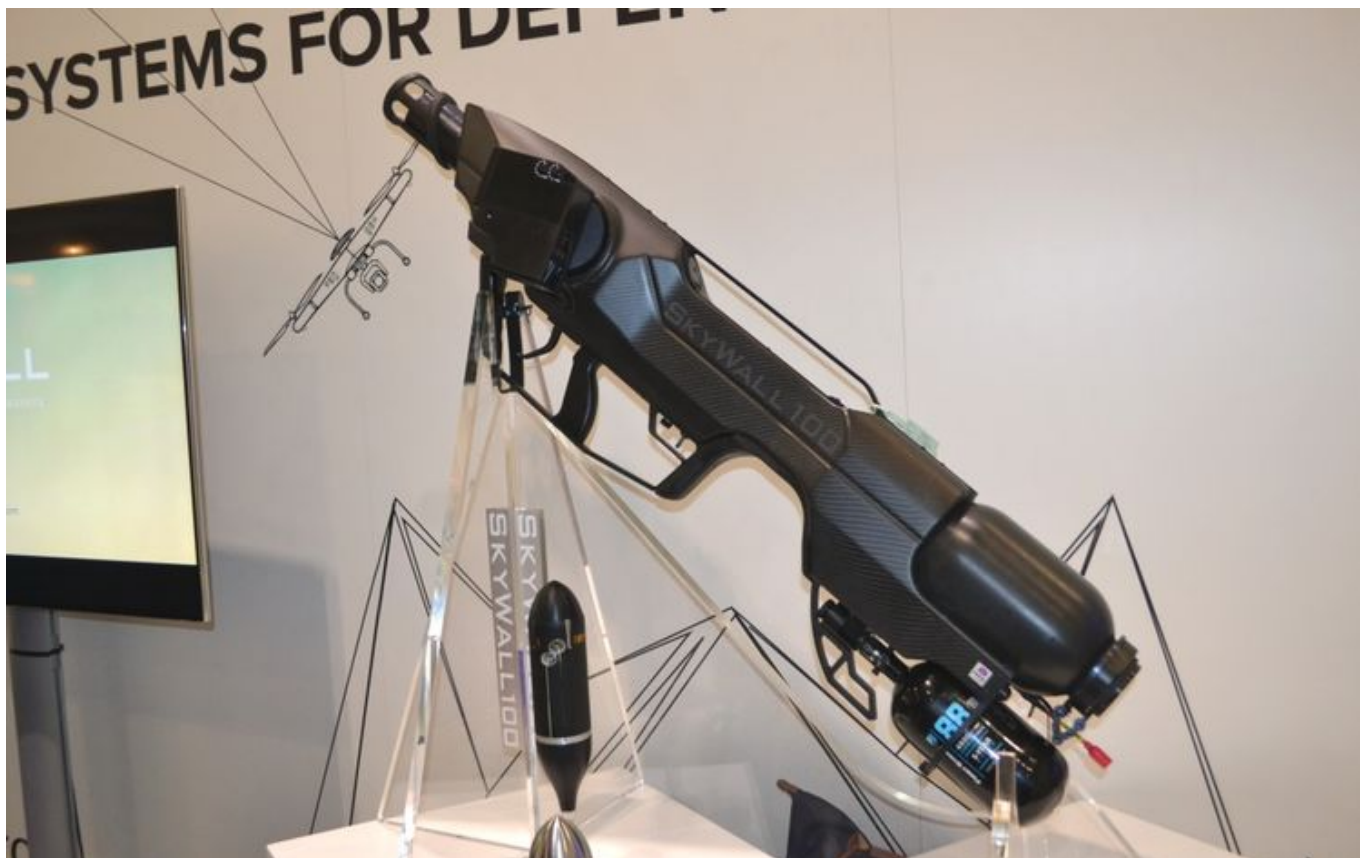
Ręczny system antydronowy Skywall 100 pneumatycznie wyrzuca granat z siatką mechanicznie blokującą nadlatujące drony. Fot. M.Dura
