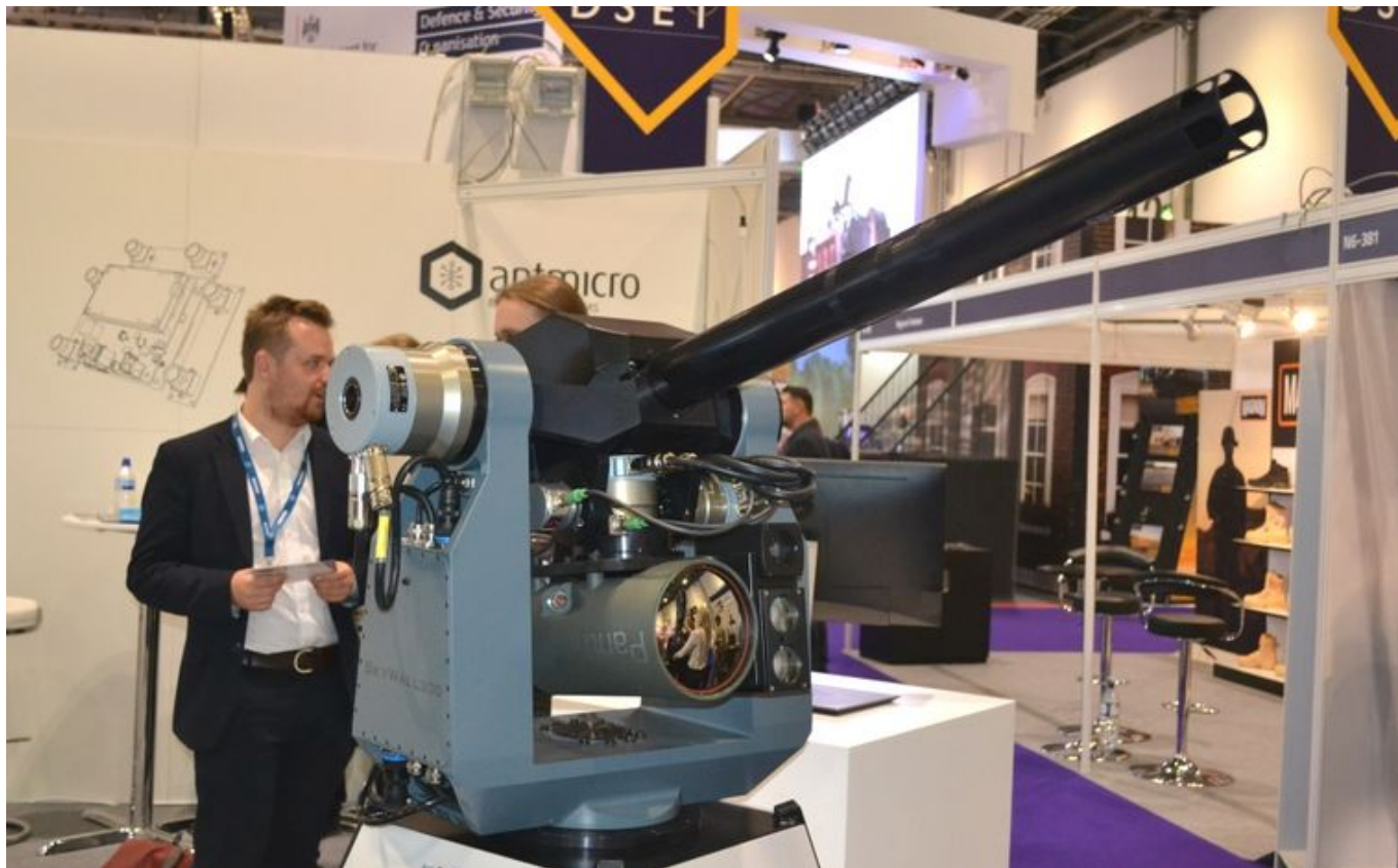
Stacjonarny zestaw antydronowy Skywall 300 wyrzuca pneumatycznie granat z siatką na większe odległości niż wersja ręczna Skywall 100 i jednocześnie wykorzystuje większą, optoelektroniczną głowicę śledzącą. Fot. M.Dura
