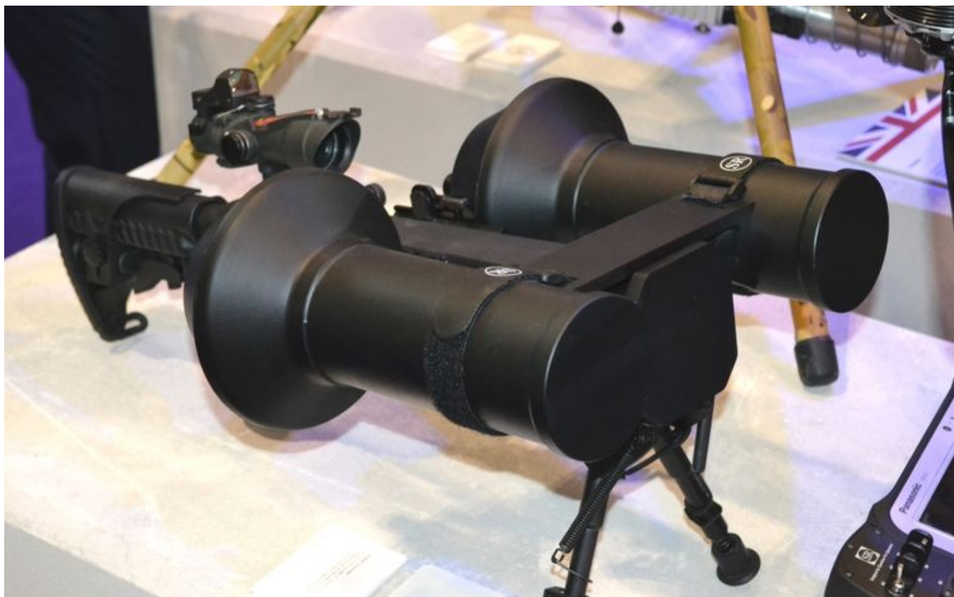
Cyfrowy, ręczny zakłócacz dronów NightFighter Digital firmy SteelRock UAV Solutions. Fot. M.Dura
