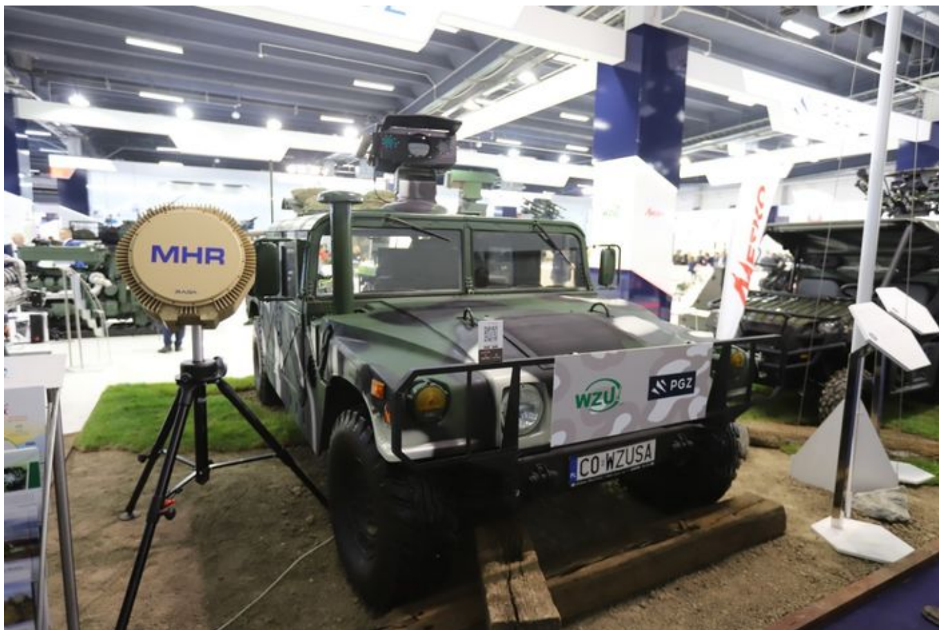
Demonstrator systemu antydronowego ICARX zamontowany na pojeździe Humvee z widoczną obok, jeszcze nie zintegrowaną anteną radaru MHR firmy Rada. Fot. M.Dura
