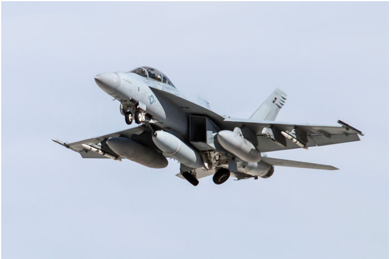
System IRST21 na myśliwcu Super Hornet. Fot. Lockheed Martin
