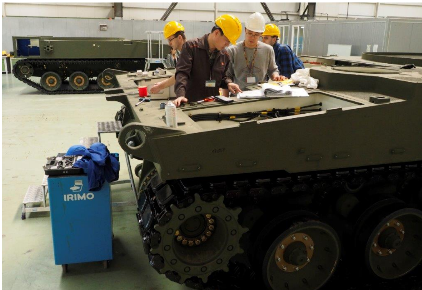
HSW ma już za sobą etap szkolenia swoich pracowników w operacjach montażu nowego typu podwozia K9PL dla sh Krab, prowadzonego z udziałem przedstawicieli licencjodawcy. Fot. Jerzy Reszczyński
