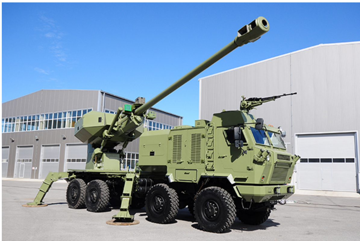
Haubica samobieźna Aleksander w pozycji ogniowej. Dobrze widoczny bezzałogowy moduł działa 155 mm i automatycznego systemu ładowania. Fot. Yugoimport
