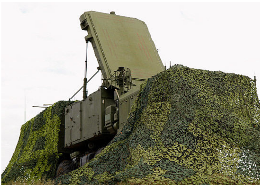
Antena radarów śledzących systemów S-300 i S-400 wynosi się obecnie w górę tylko poprzez ustawianie ich na wysokich nasypach - fot. mil.ru
