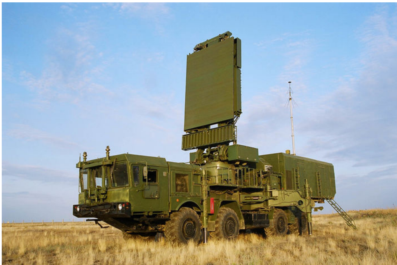
Radar obserwacji dookólnej 96Ł6-1 pracujący dla potrzeb systemu S-400 - fot. www.lems.ru
