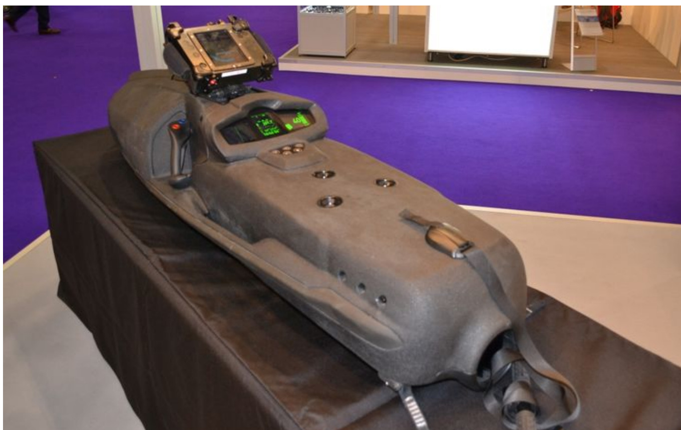
Skuter Seabob Black Shadow 730 najnowszej wersji z widoczną z tyłu uprzężą dla płetwonurka – fot. M.Dura
