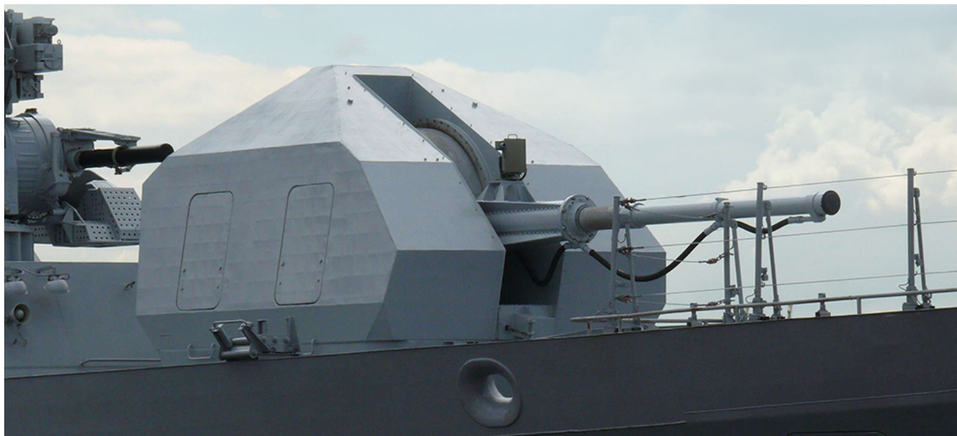
Opracowana przez instytut „Buriewiestnik” morska armata A190-01 kalibru 100 mm. Fot. OA „Centralny Instytut Badawczo - Rozwojowy „Buriewiestnik””
