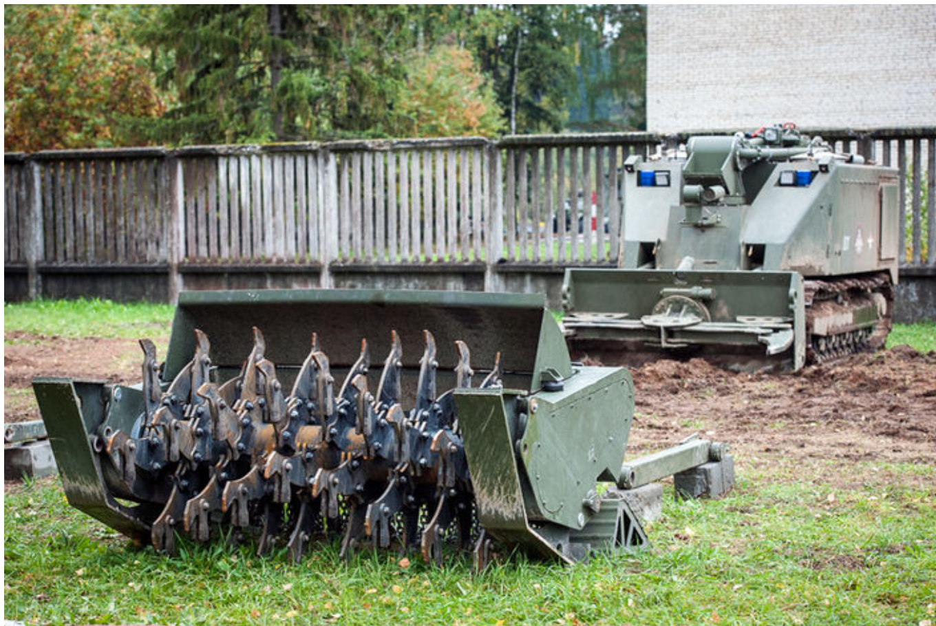
Uran - 6 może współpracować z pięcioma wymiennymi trałami - lemieszami - fot. function.mil.ru
