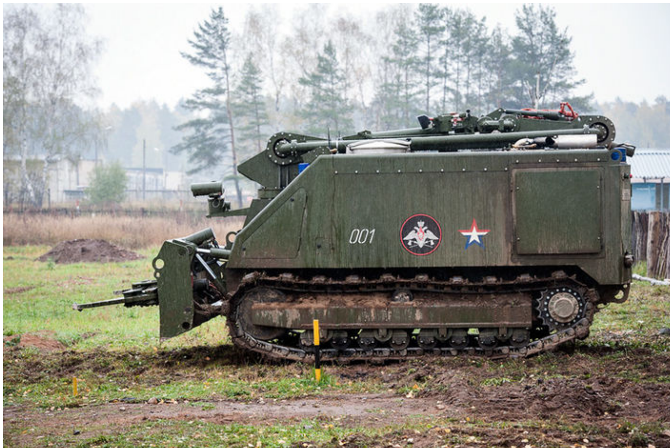
Prototypowy robot saperski Uran - 6 o numerze 001 - fot. function.mil.ru
