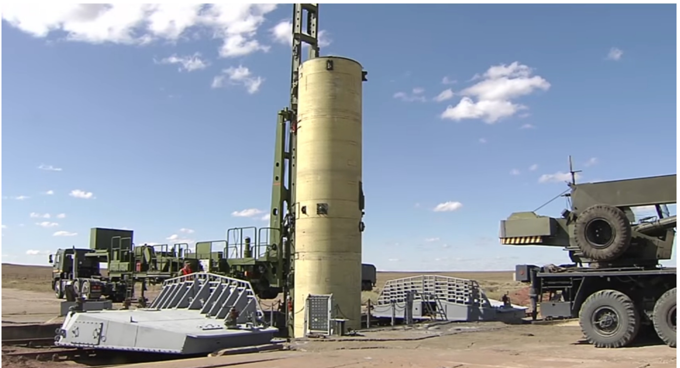
Przecirakieta PRS-1M jest wsuwana do silosu podziemnego razem z kontenerem startowym. Fot. mil.ru/YouTube
