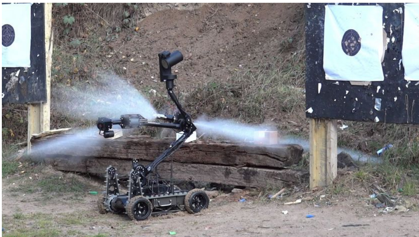
Zrobotyzowane urządzenie do rozpoznania i neutralizacji ładunków niebezpiecznych. Robot PIAP GRYF Fot. PIAP
