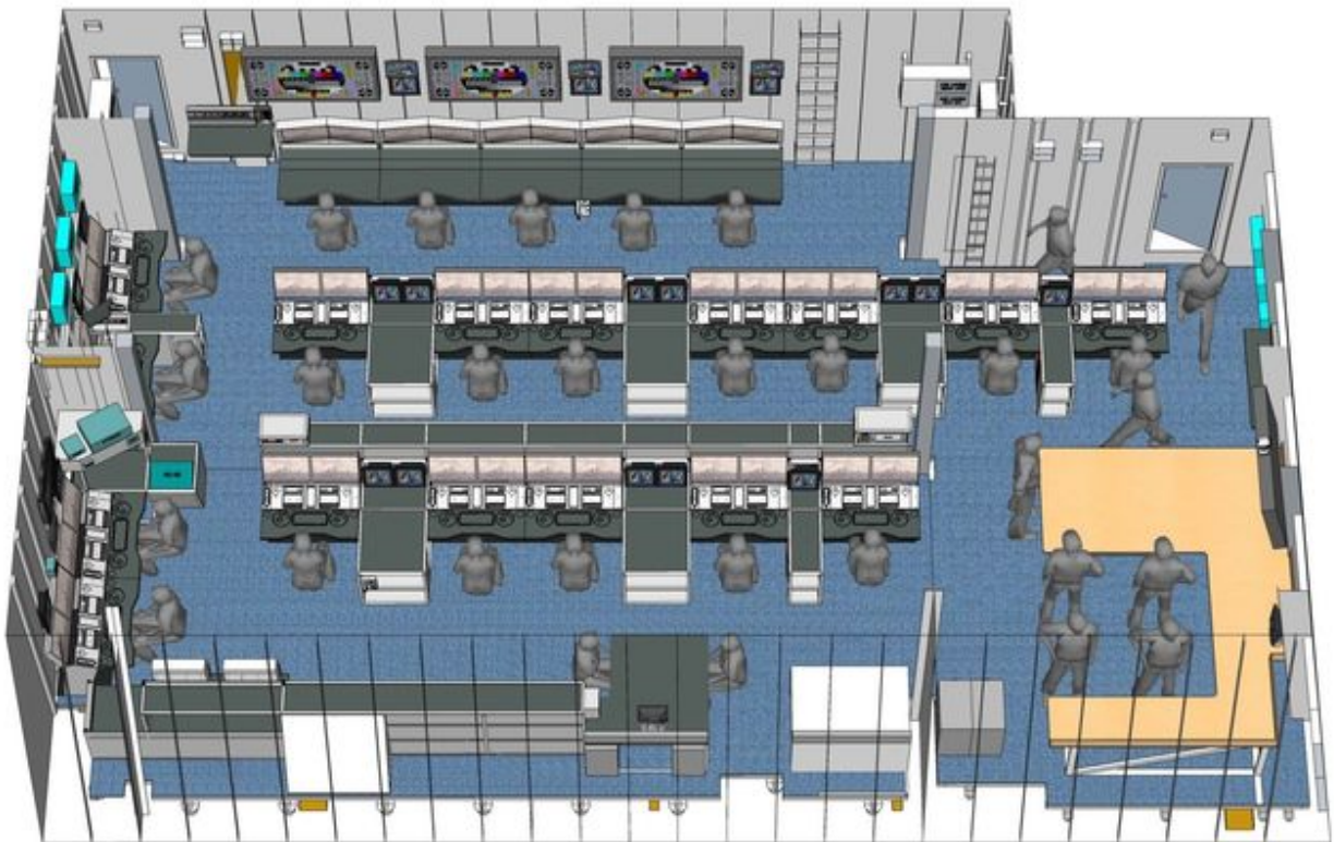
Układ Bojowego Centrum Informacyjnego na duńskich fregatach – fot. Søværnet/Rada Budowy Okrętów
