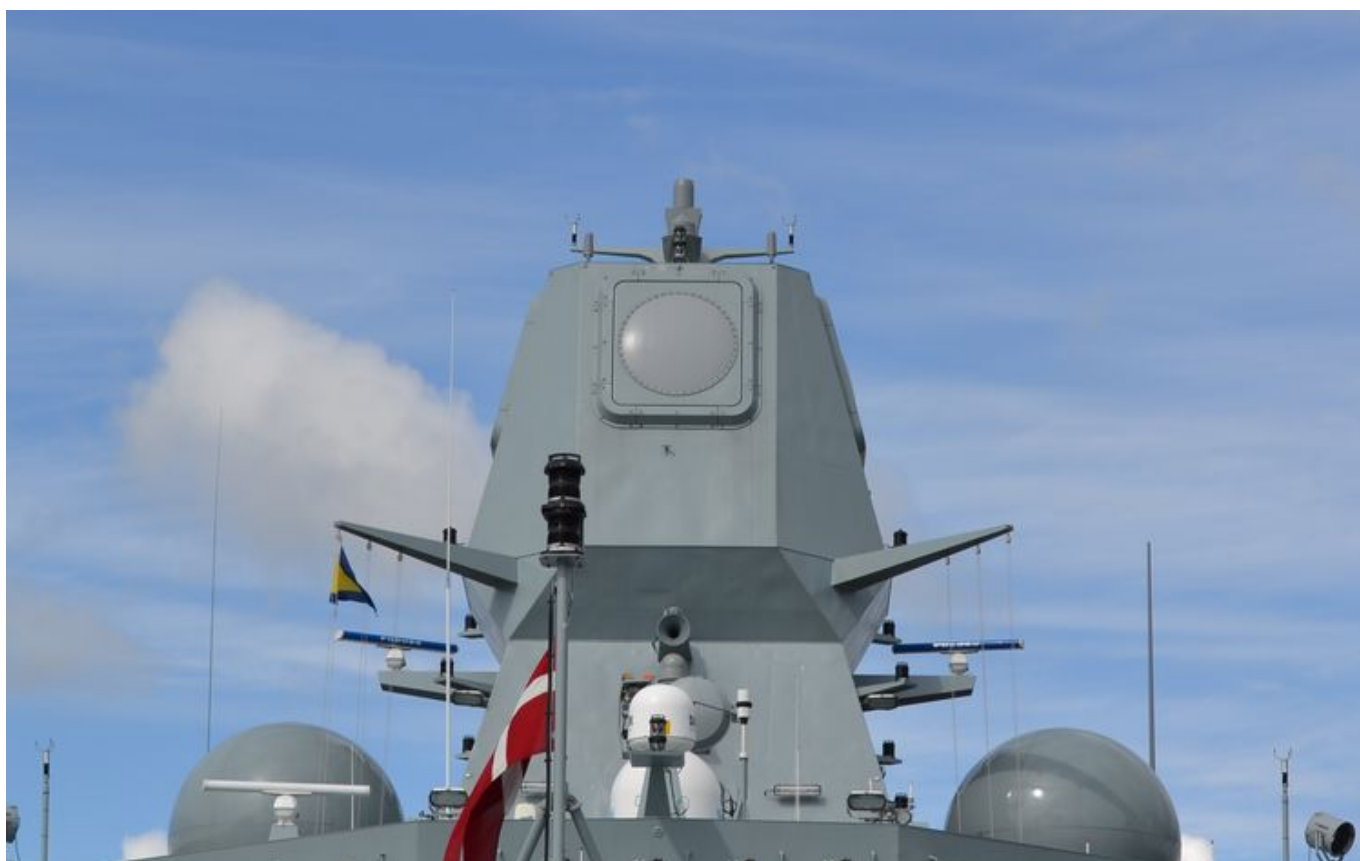
Radar APAR daje okrętom typu Iver Huitfeldt podobne możliwości, jakie mają okręty klasy AEGIS - fot. M.Dura
