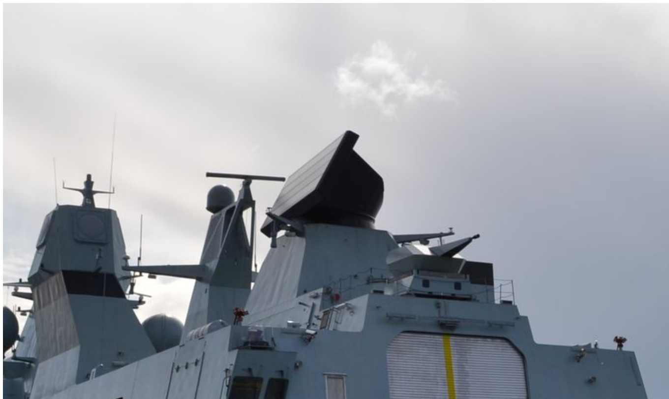
Radary trójwspółrzędny typu SMART-L ma zasięgu ponad 400 km, a więc większy niż radary na amerykańskich niszczycielach typu Arleigh Burke klast AEGIS – fot. M.Dura
