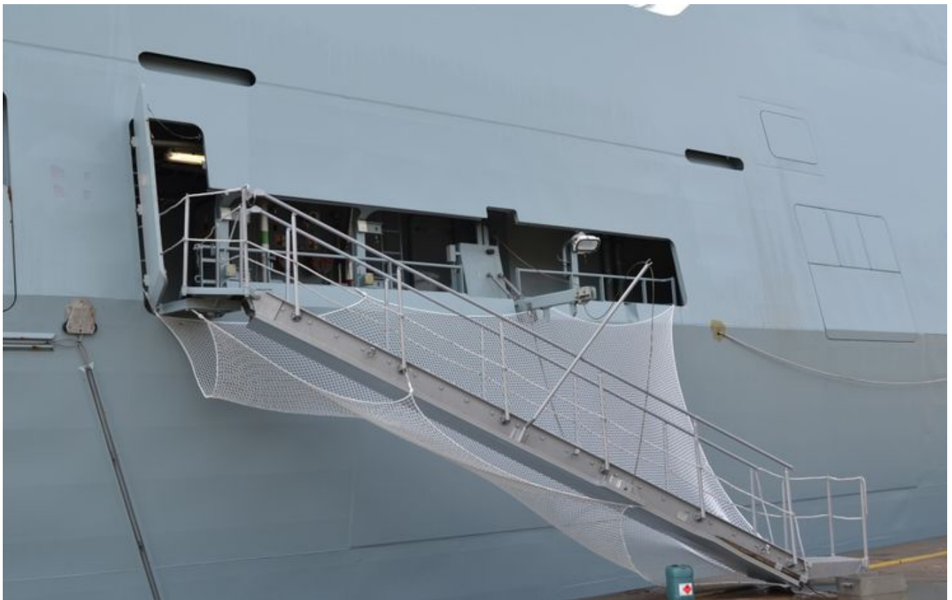
Okręty typu Iver Huitfeldt są zbudowane w technologii stealth o czym świadczy np. konstrukcja trapu wkomponowanego w burty – fot. M.Dura
