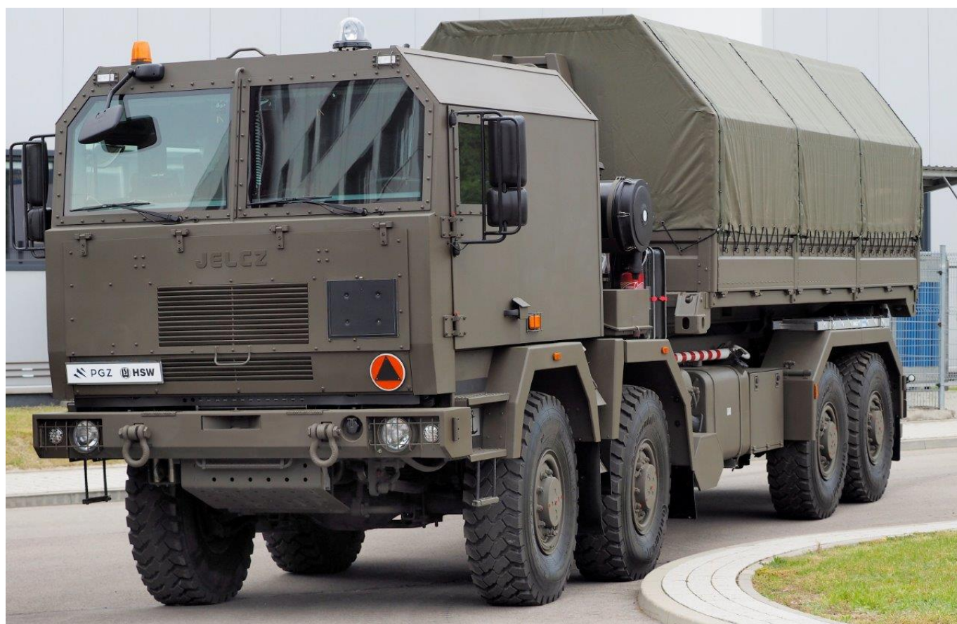
Artyleryjski Wóz Amunicyjny AWA „jeździ” na samochodzie ciężarowym Jelcz 882.53 z dwuosobową opancerzoną kabiną i służy do przewozu oraz zautomatyzowanego załadunku i rozładunku amunicji moździerzowej 120 mm, zabierając „na pokład” 6 pałeczek pociskami. Fot. Jerzy Reszczyński/Defence24.pl
