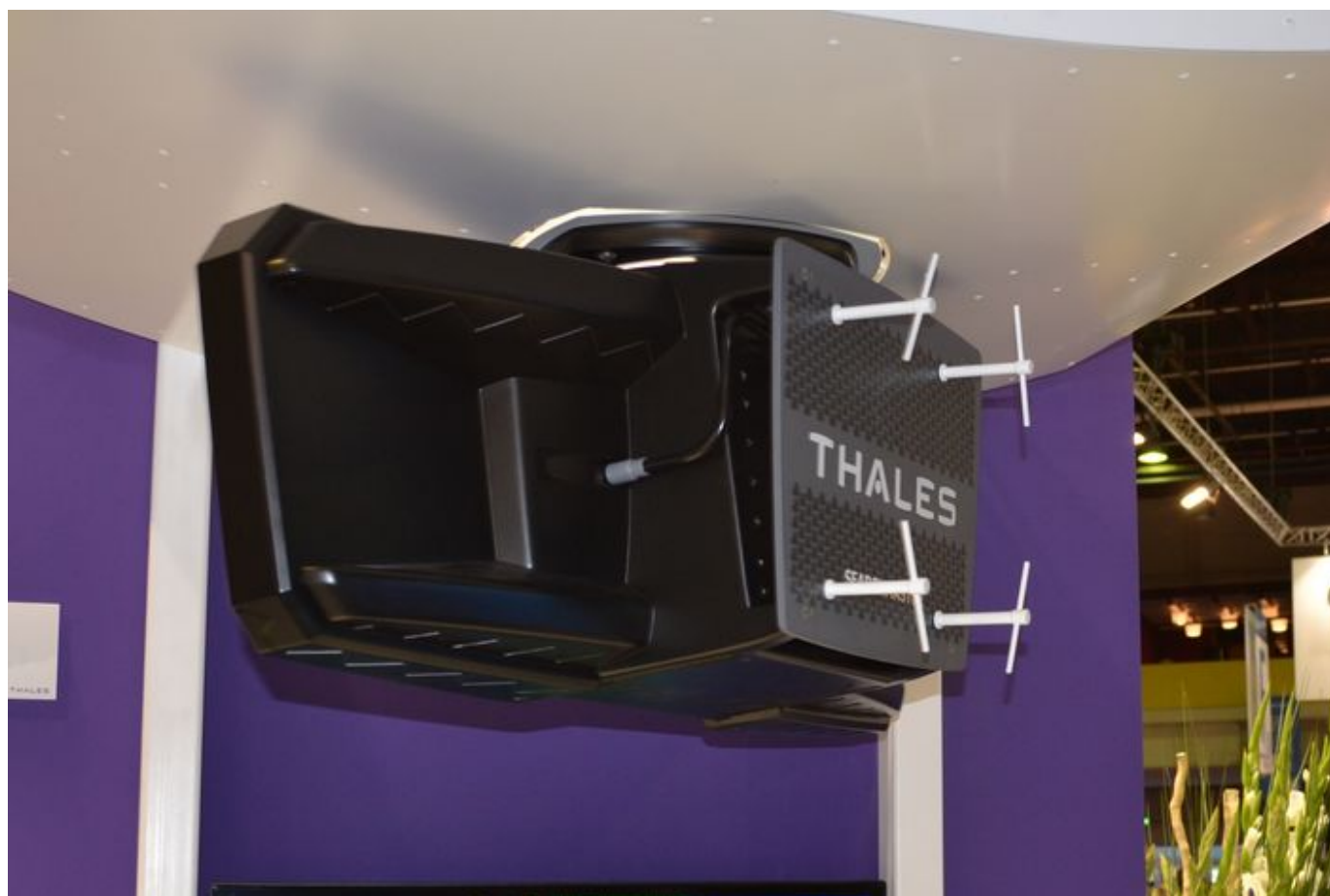
Antena systemu IFF z tyłu radaru Searchmaster. Fot. M.Dura
