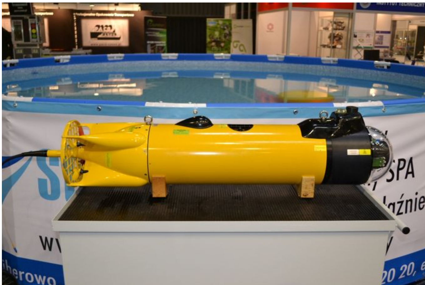
Zdalnie sterowany, samobieżny ładunek wybuchowy jednorazowego użytku typu GŁUPTAK - fot. M.Dura
