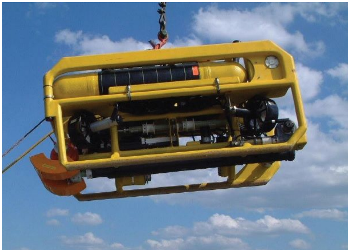
Pojazd Ukwiąg z podczepionym do specjalnego ramienia ładunkiem wybuchowym TOCZEK B – fot. OBR CTM
