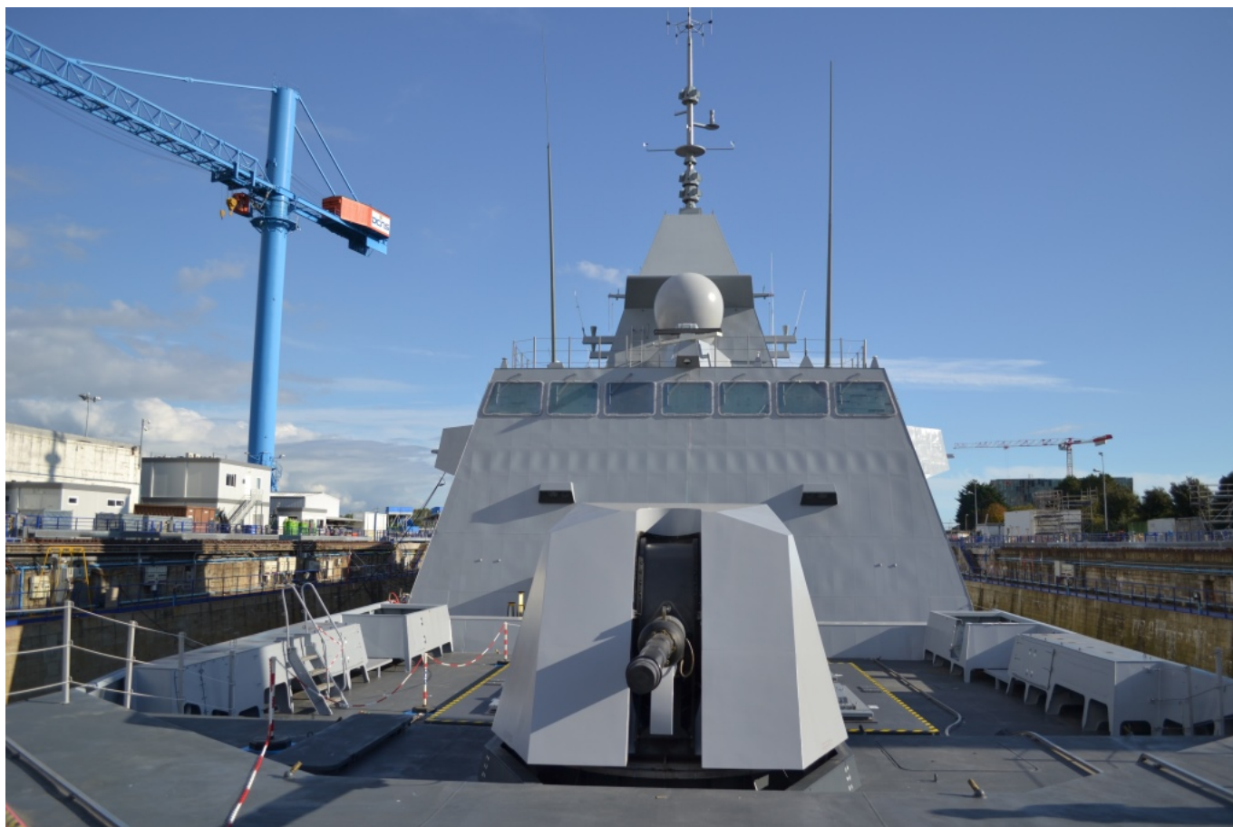
Stocznia Fincentieri Marine zaproponowała dla programu FFG(X) zamerykanizowaną wersję fregaty wielozadaniowej FREMM. Ich zaletą jest dużo miejsca na pokładzie dziobowym do zamontowania wyrzutni pionowego startu. Fot. M.Dura
