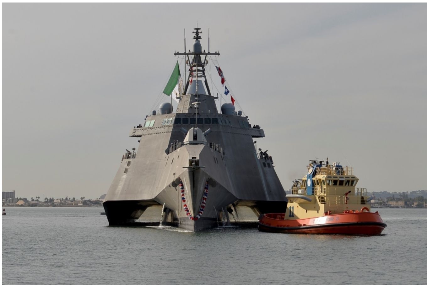
Stocznia Austal USA przygotowuje projekt fregaty FFG(X) oparty na trzykadłubowym okręcie do działań przybrzeżnych typu Independence. Na zdjęciu USS „Coronado” (LCS 4) Fot. US Navy
