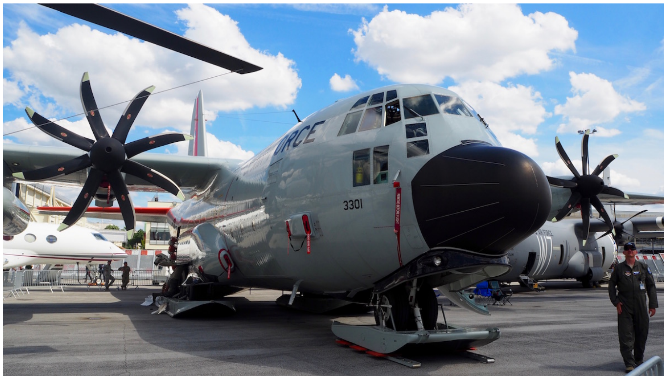
Dobrze widoczne ośmiopłatowe śmigła oraz płozy podwozia "śnieżnego" LC-130H Hercules.
