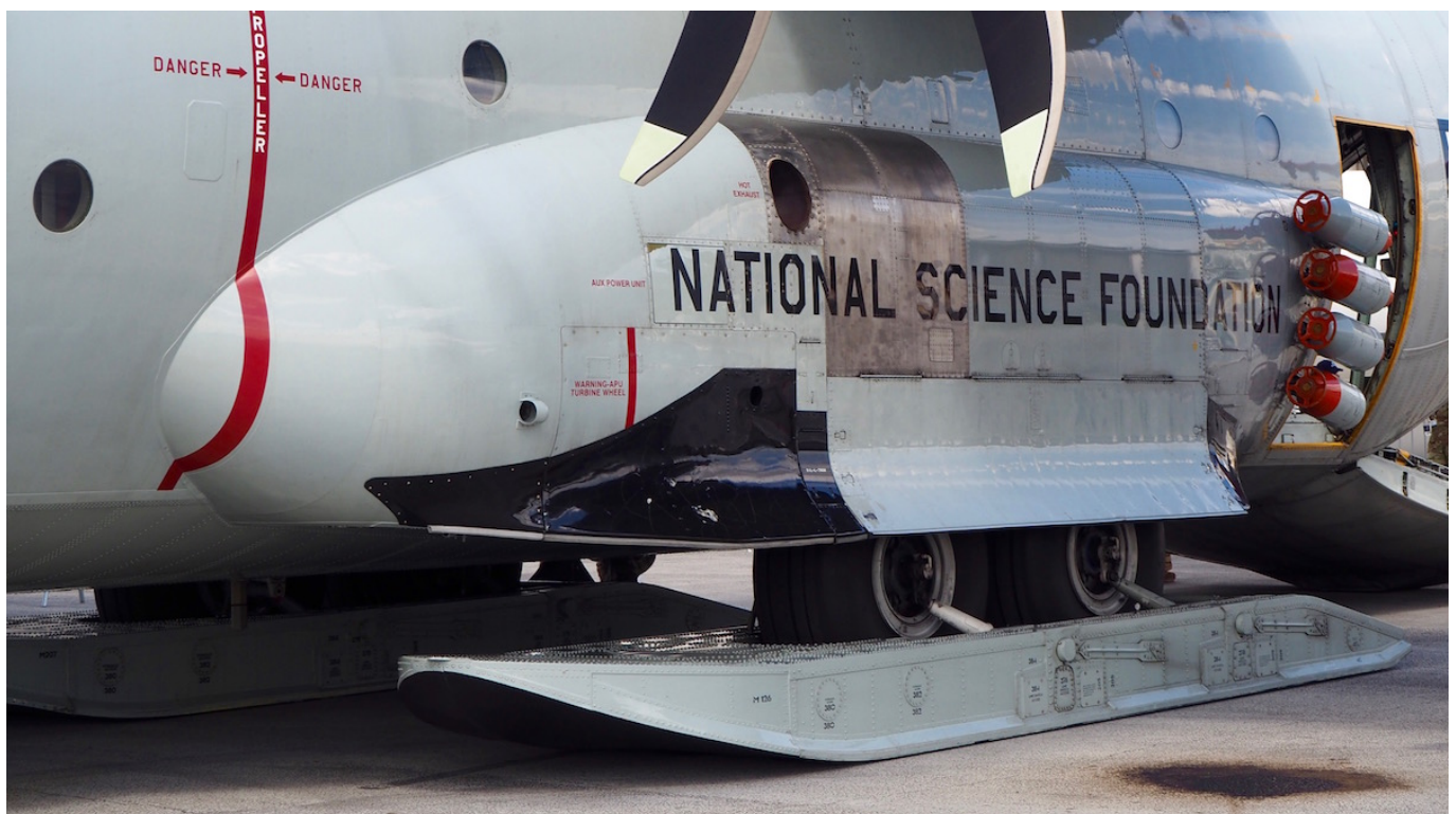
Dobrze widoczne płozy podwozia głównego i silniki startowe JATO. Fot. j.Sabak
