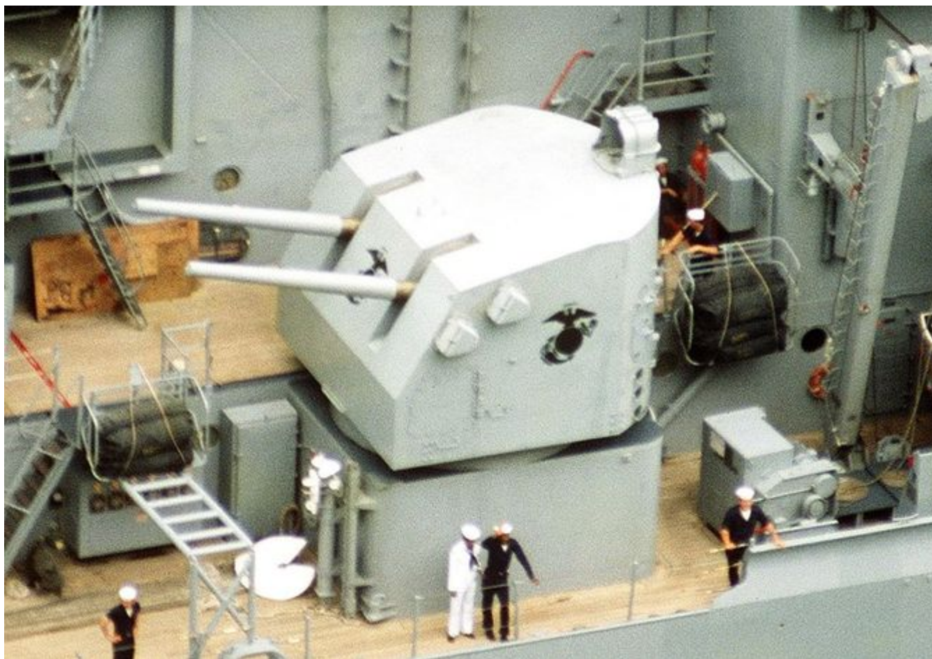
Duże znaczenie w działaniach przeciwko celom na lądzie mogłyby mieć armaty kalibru 127 mm rozmieszczone na burtach pancerników typu Iowa. Fot. Wikipedia
