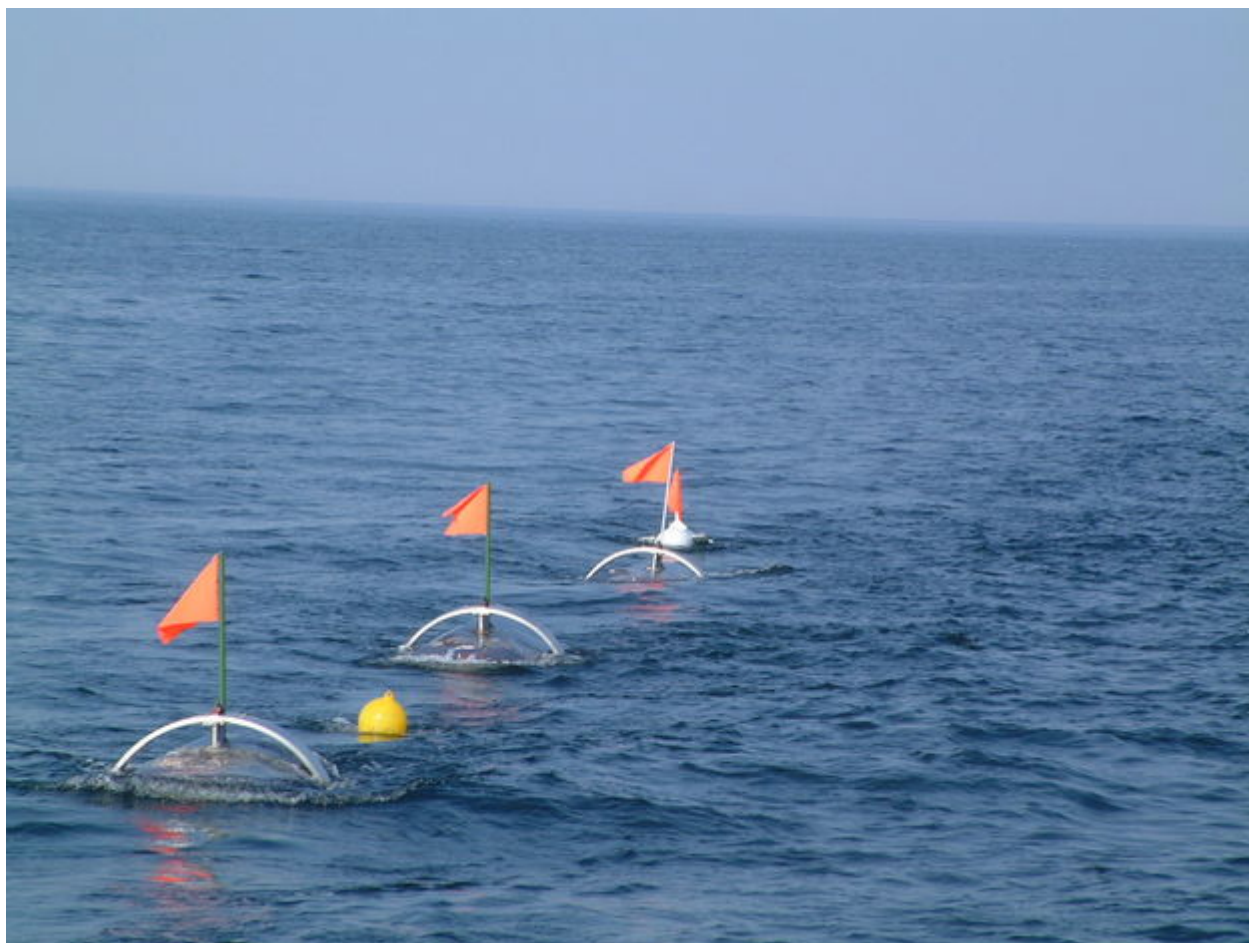
Kompletny system trałowy MLM w konfiguracji z trzema wzbudnikami magnetycznymi i z holowanym na końcu trałem akustycznym w czasie prób w Breście - fot. OBR CTM S.A.
