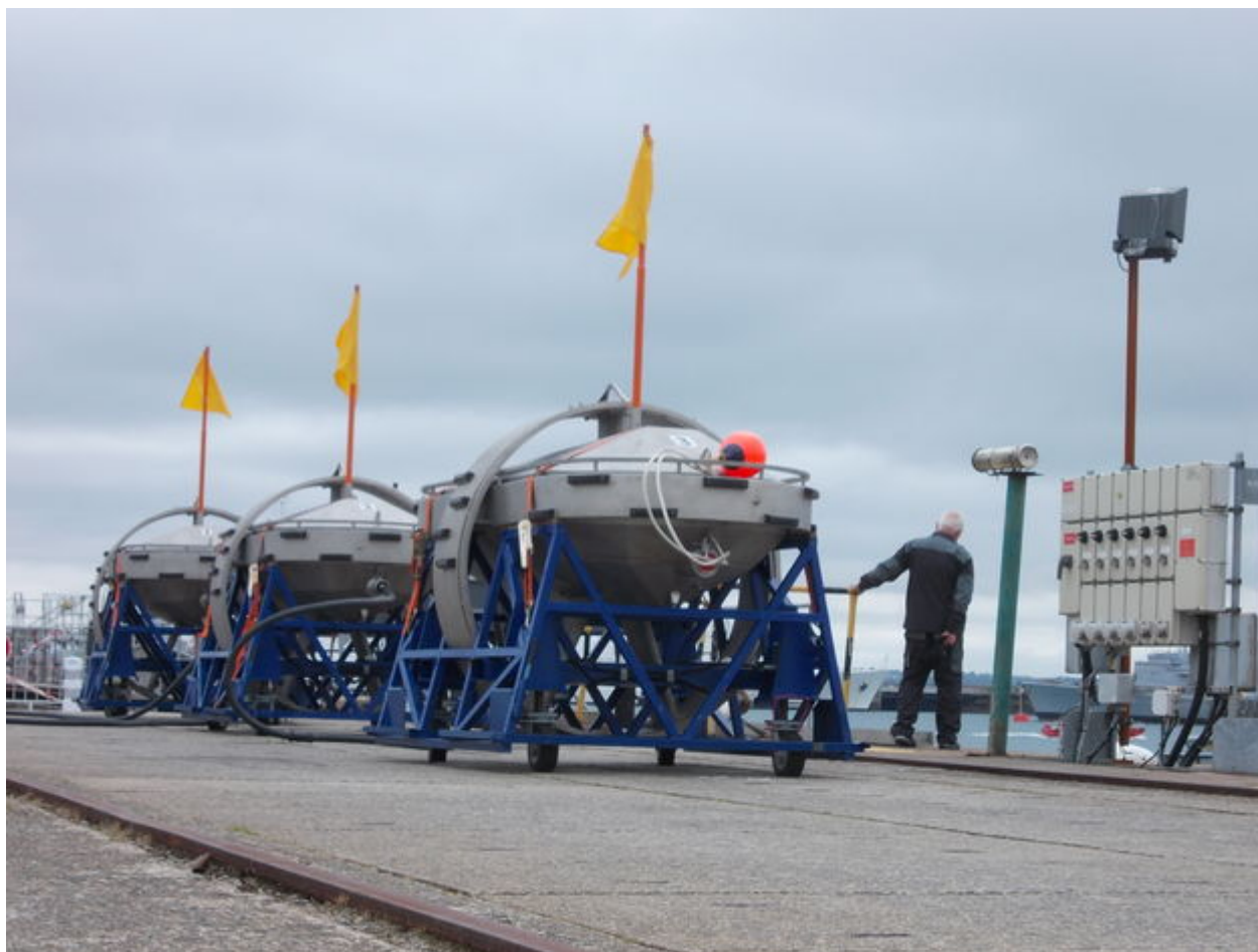
Trał MLM w konfiguracji z trzema wzbudnikami magnetycznymi przed próbami w Breście – fot. OBR CTM S.A.
