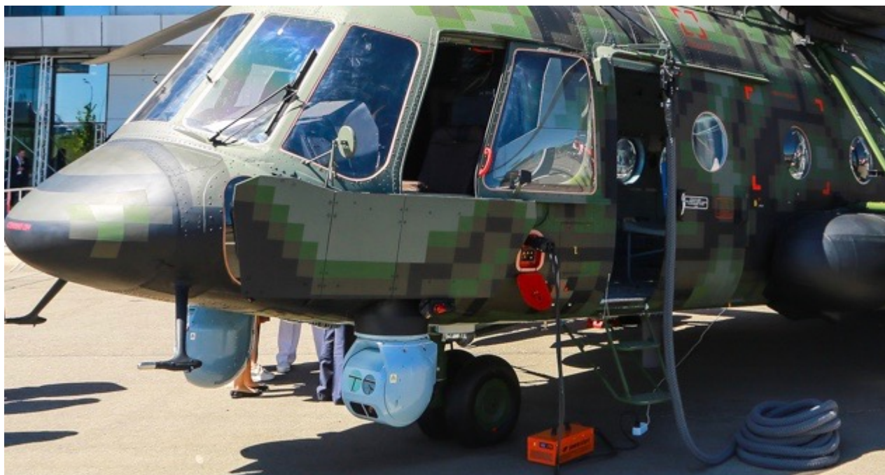
Dwie głowice optoelektroniczne pod nosem Mi-171Sz-NW, opancerzenie kabiny oraz lina desantowa. Fot. Rostec
