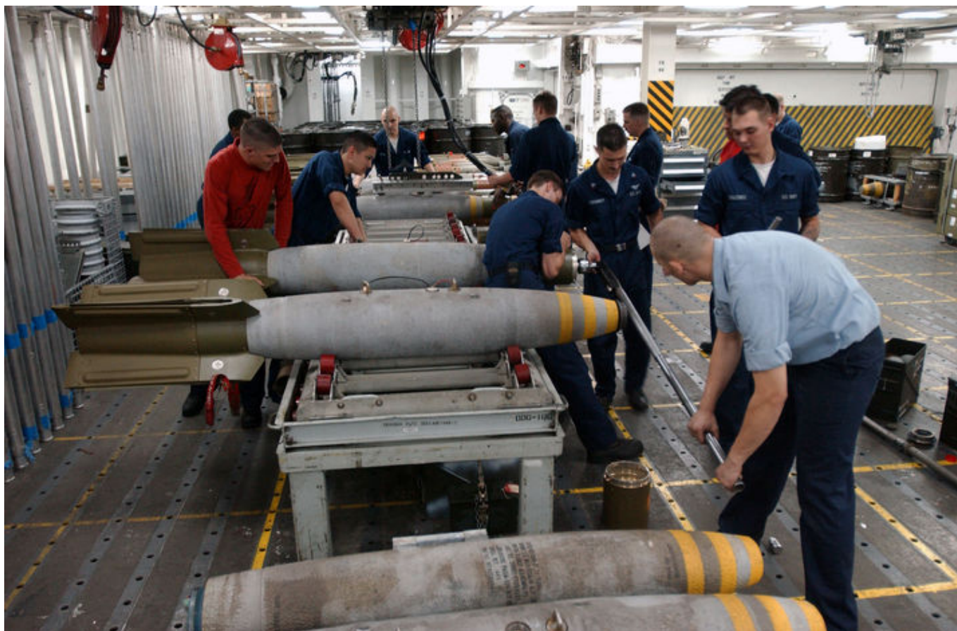
Marynarze na pokładzie amerykańskiego lotniskowca montują zestawy GBU-12 Paveway II do bomb Mk 82, fot. US Navy
