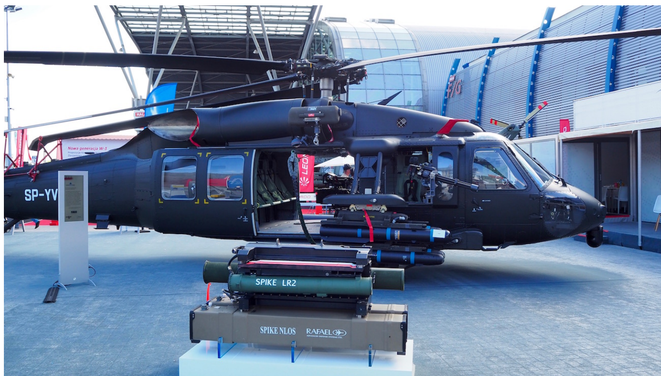
Pociski Spike oraz Hellfire mogą stanowić uzbrojenie S-70i Black Hawk. Fot. J.Sabak
