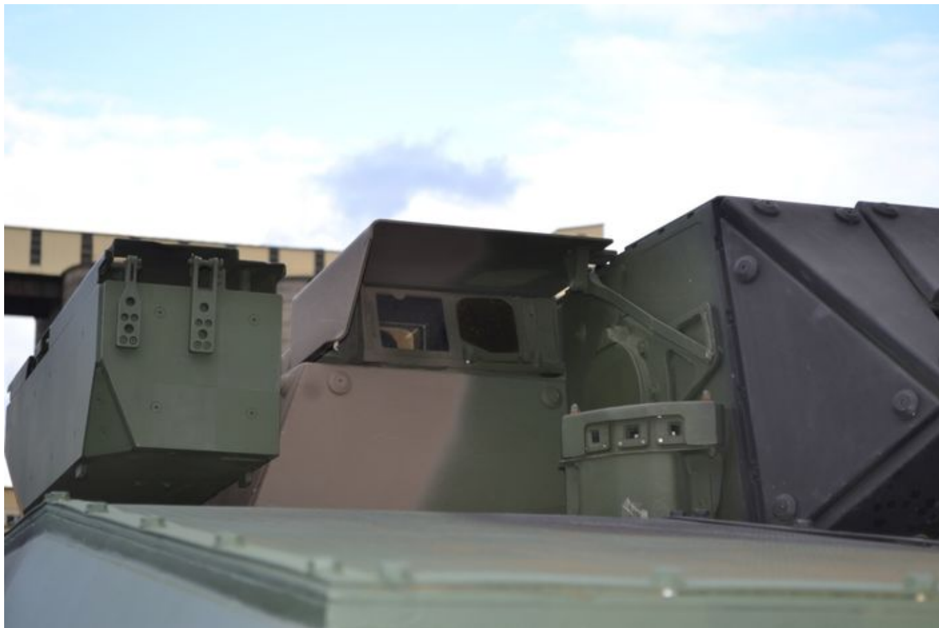
Głowica detekcyjna systemu samoosłony SSP-1 OBRA-3 zamontowana na BWP Anders. Fot. M.Dura
