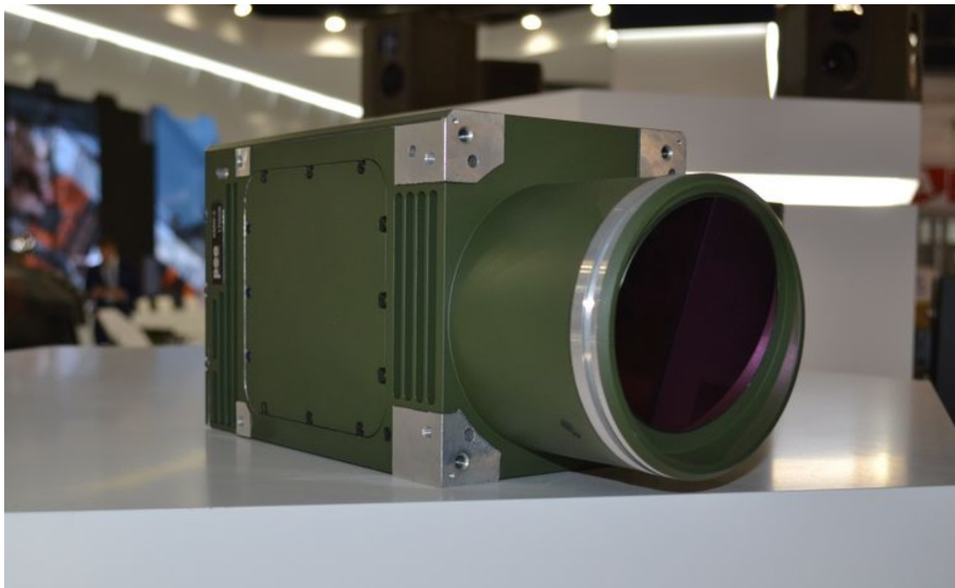
Średniofalowa kamera termowizyjna KMW-3 „Temida” . Fot. M.Dura
