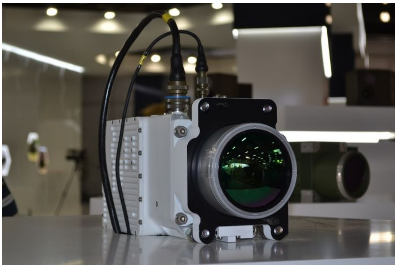
Długofalowa kamera termowizyjna KLW-1R „Asteria” . Fot. M.Dura
