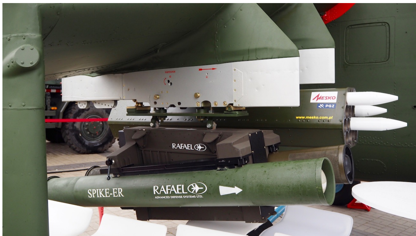
Pociski Spike-ER i Spike -LR pod skrzydłem Mi-24. W tle wyrzutnia pocisków niekierowanych 70 mm. Fot. J.Sabak
