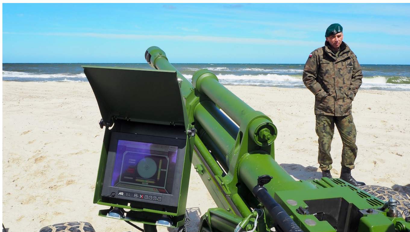
Ekran komputera balistycznego haubicy 105 mm LG1 Mk III. Fot. J.Sabak
