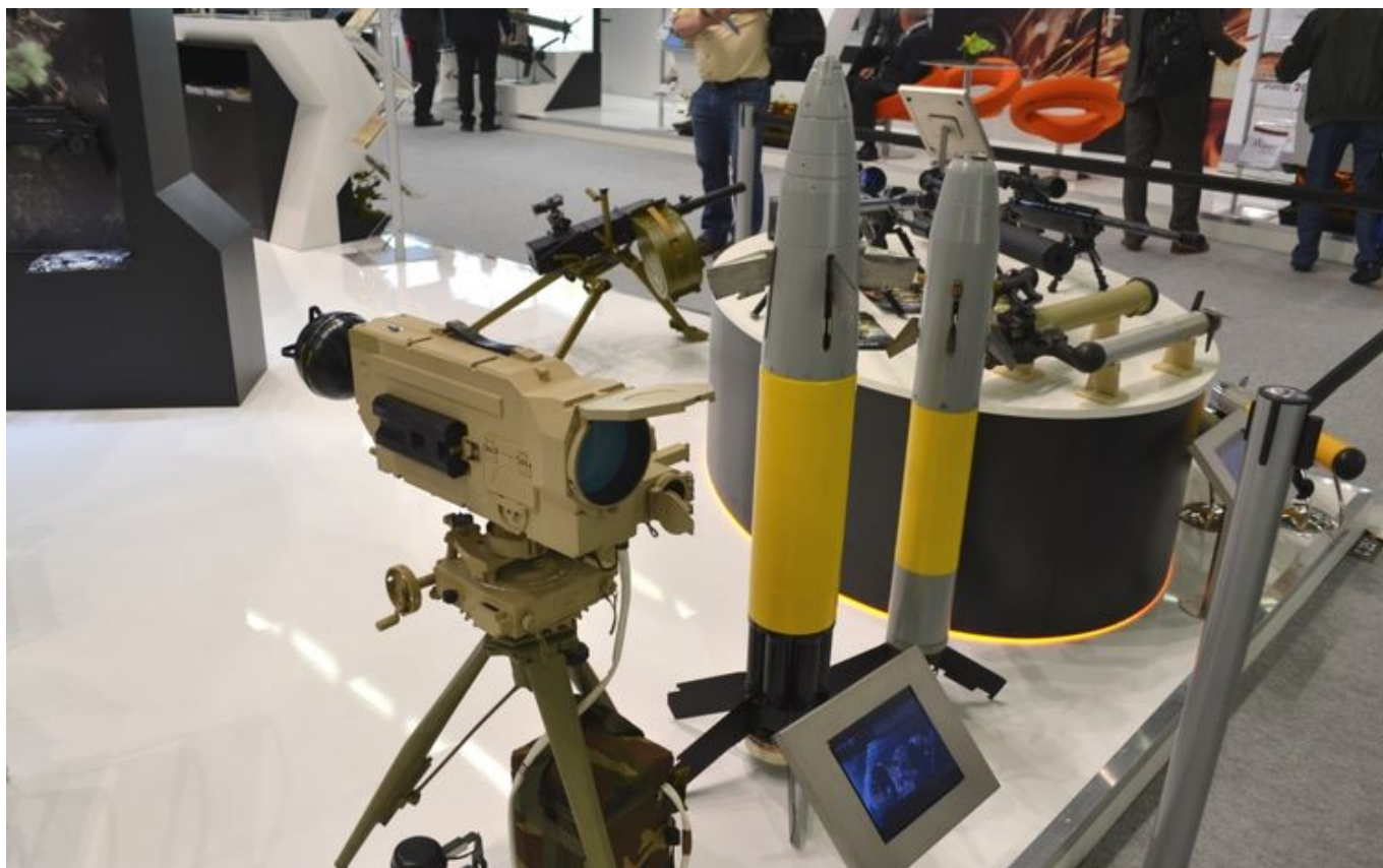
Rosyjski laserowy podświetlacz celu Malachit oraz naprowadzane nim: pocisk artyleryjski Krasnopol-M2 kalibru 152 mm i moździerzowy Gran kalibru 120 mm. Fot. M.Dura
