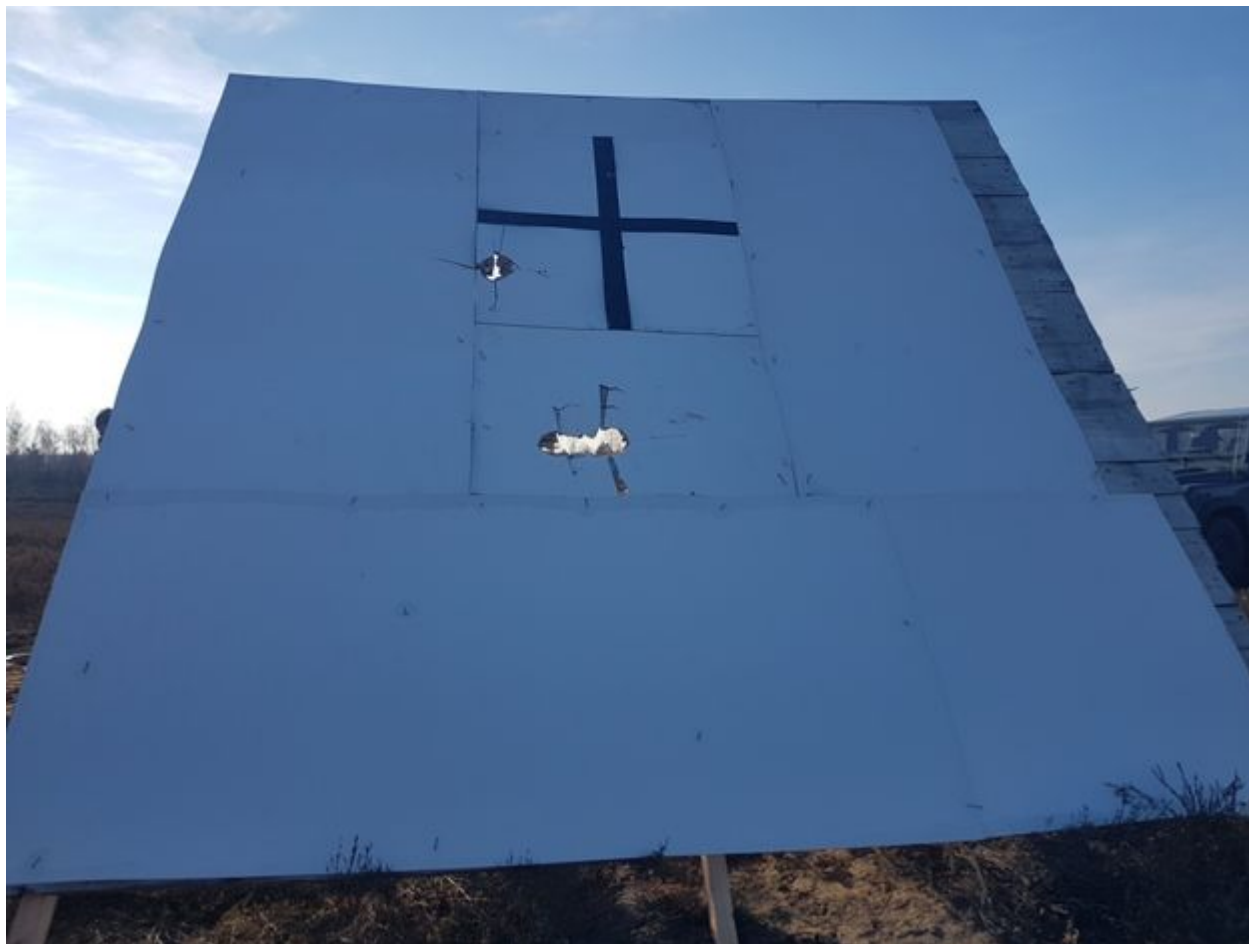
Miejsce trafienia dwóch pocisków APR 155 wystrzelonych z odległości ponad 15 km w tarczy oświetlonej laserowym podświetlaczem celu LPC-1. Fot. Telesystem Mesko
