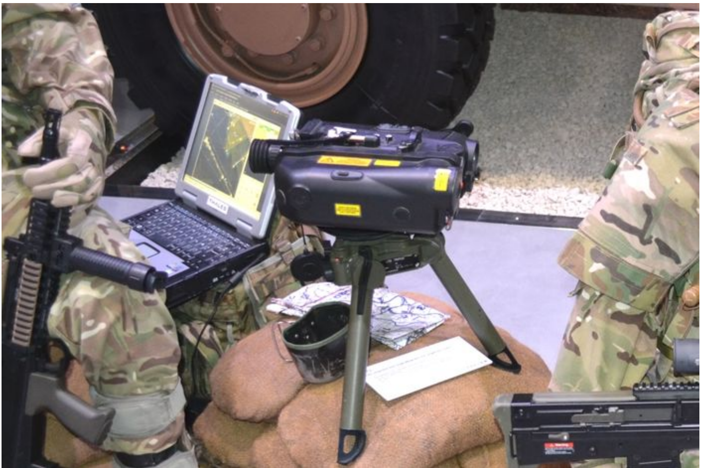
Zintegrowany laserowy podświetlacz celu i dalmierz proponowany przez koncern Thales. Fot. M.Dura
