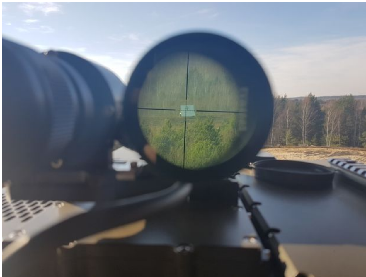
Widok na cel z lunetki zamontowanej na laserowym podświetlaczu celu LPC-1. Fot. Telesystem Mesko
