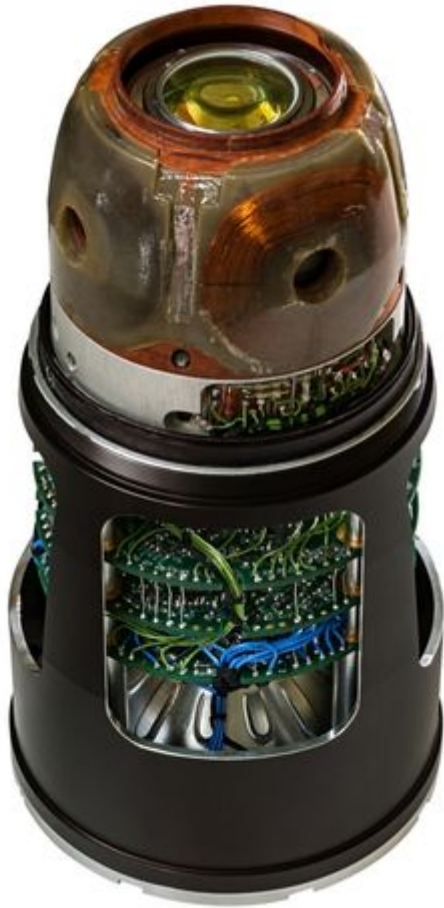
Układ laserowego naprowadzania pocisku APR kalibru 155 mm. Fot. Telesystem Mesko
