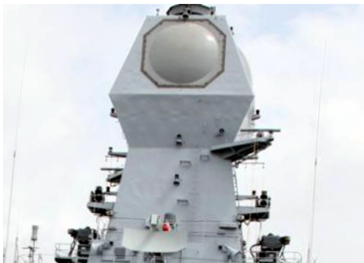
Radar EL/M-244 MF-STAR z aktywnymi antenami ścianowymi AESA. Fot. Indian Navy/Wikipedia
