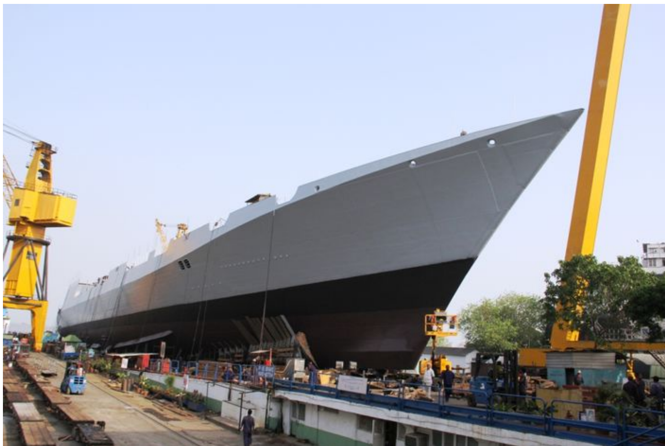
Kadłub pierwszego niszczyciel projektu 15B Visakhapatnam w stoczni Mazagaon Dock Limited w Bombaju. Fot. Indian Navy/Wikipedia
