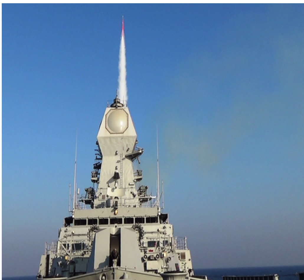
Głównym uzbrojeniem przeciwlotniczym okrętów typu Kolkata jest izraelski, raketowy system pionowego startu Barak. Fot. Indian Navy/Wikipedia
