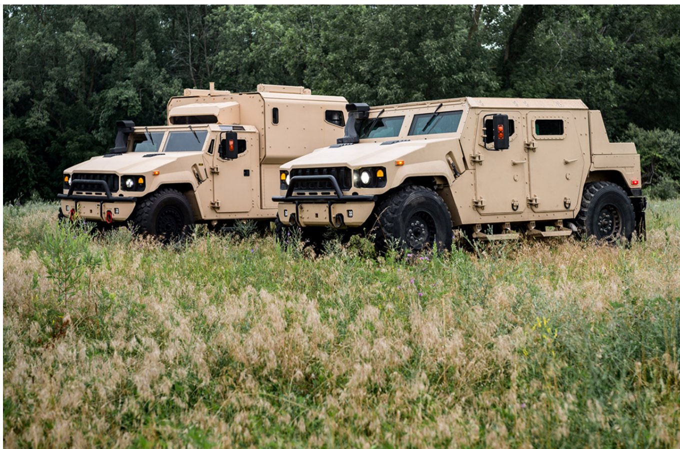
Projekt MPT to próba połączenia militarnych genów Humvee (np. rama, zwieszanie) z komercyjnymi podzespołami (np. przekładania Allisona) w celu skrojenia pojazdu pod wymagania konkretnego odbiorcy. Fot. AM General
