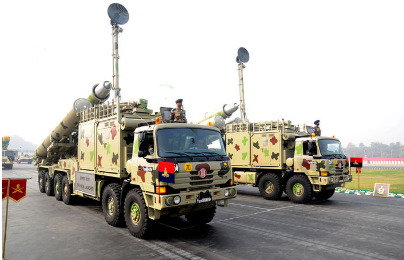
Wyrzutnia lądowej wersji pocisku Brahmos osadzona na podwoziu Tatra - Fot. Hemantphoto79/Wikimedia Commons, CC BY-SA 3.0
