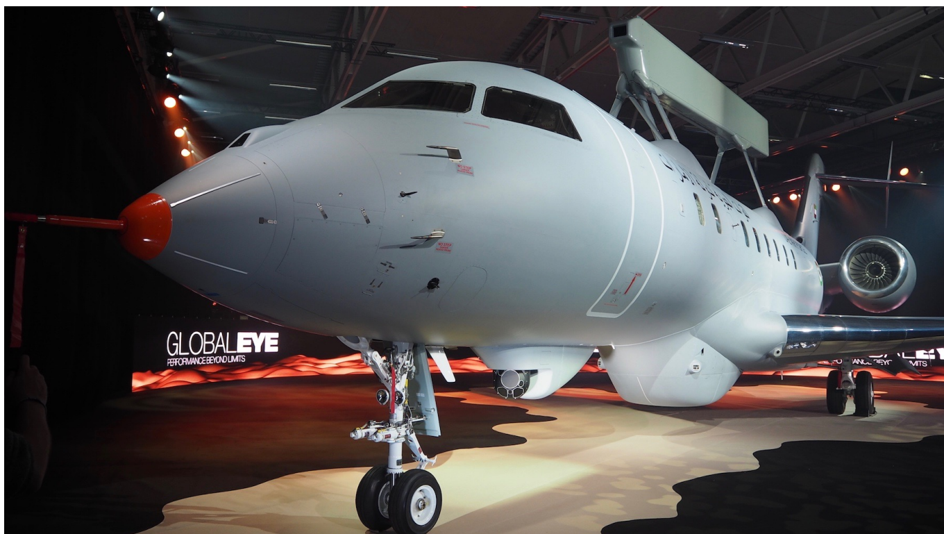
Dobrze widoczne sensory samolotu GlobalEye: Radar Erieye ER nad kadłubem oraz radar Selex ES Seaspray 7500E i głowica optoelektroniczna FLIR Star Safire 380HD pod kadłubem. Fot. Juliusz Sabak
