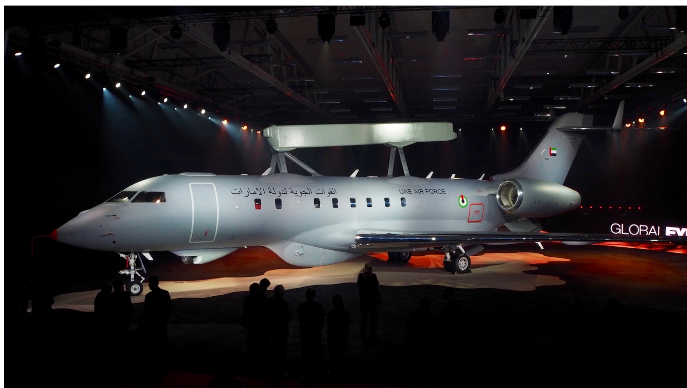
Nośnikiem systemu GlobalEye jest znacznie zmodyfikowany bizjet Bombardier Global 6000. Fot. Juliusz Sabak
