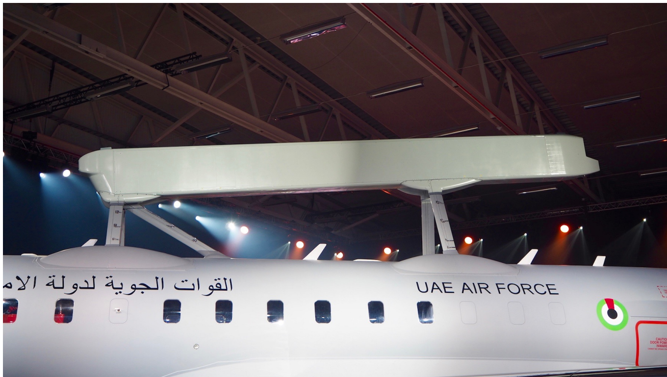
Główny radar maszyny - Erieye ER w charakterystycznej "belce" ponad kadłubem ma pole widzenia ponad 300 stopni. Fot. Juliusz Sabak
