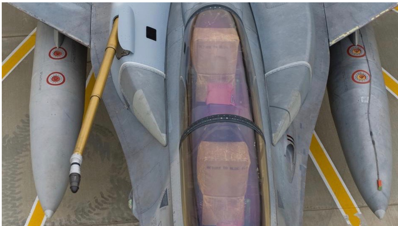
Sonda do tankowania systemu CARTS podczas testów na F-16 Block 60. Fot. Lockheed Martin's Advanced Development Programs
