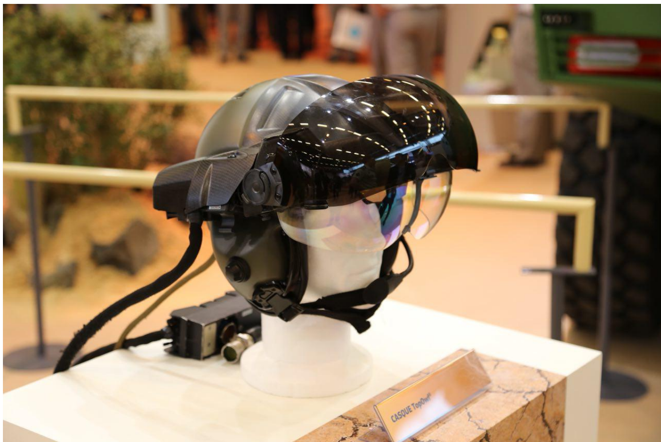
Hełm TopOwl z wbudowanym wyświetlaczem stanowi element wyposażenia NH90FS, umożliwiający zastosowanie rozszerzonej rzeczywistości. Fot. Paweł K. Malicki
