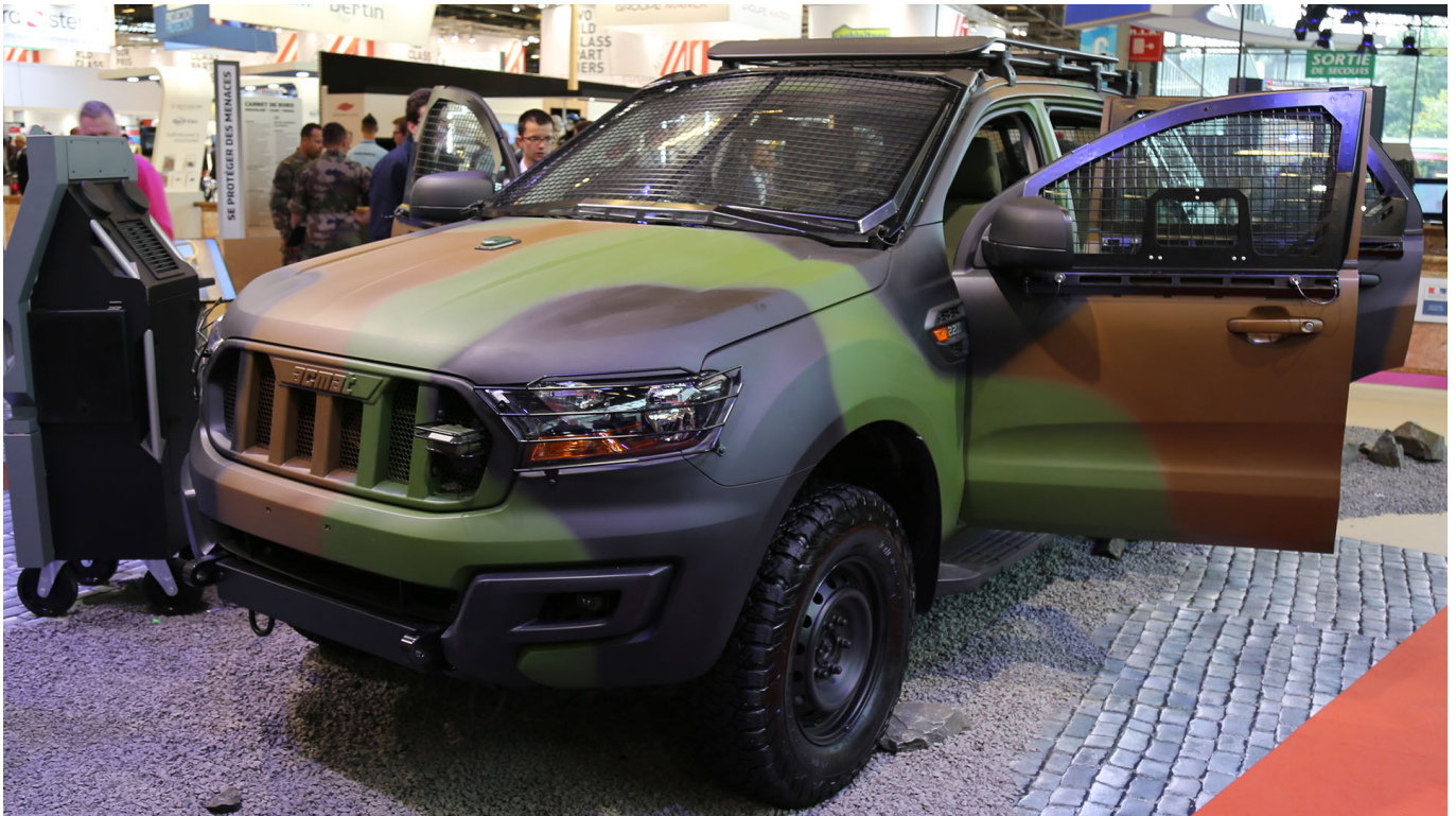
VLTP-NP w wersji z osłonami wszystkich powierzchni szklanych fot. Paweł K. Malicki
