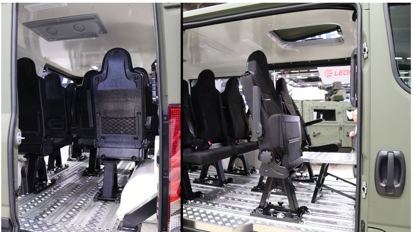
Wnętrze Iveco MUV skonfigurowanego do przewozu żołnierzy, w dachu wozu widoczny jest właz / Zdjęcie: Paweł K.
