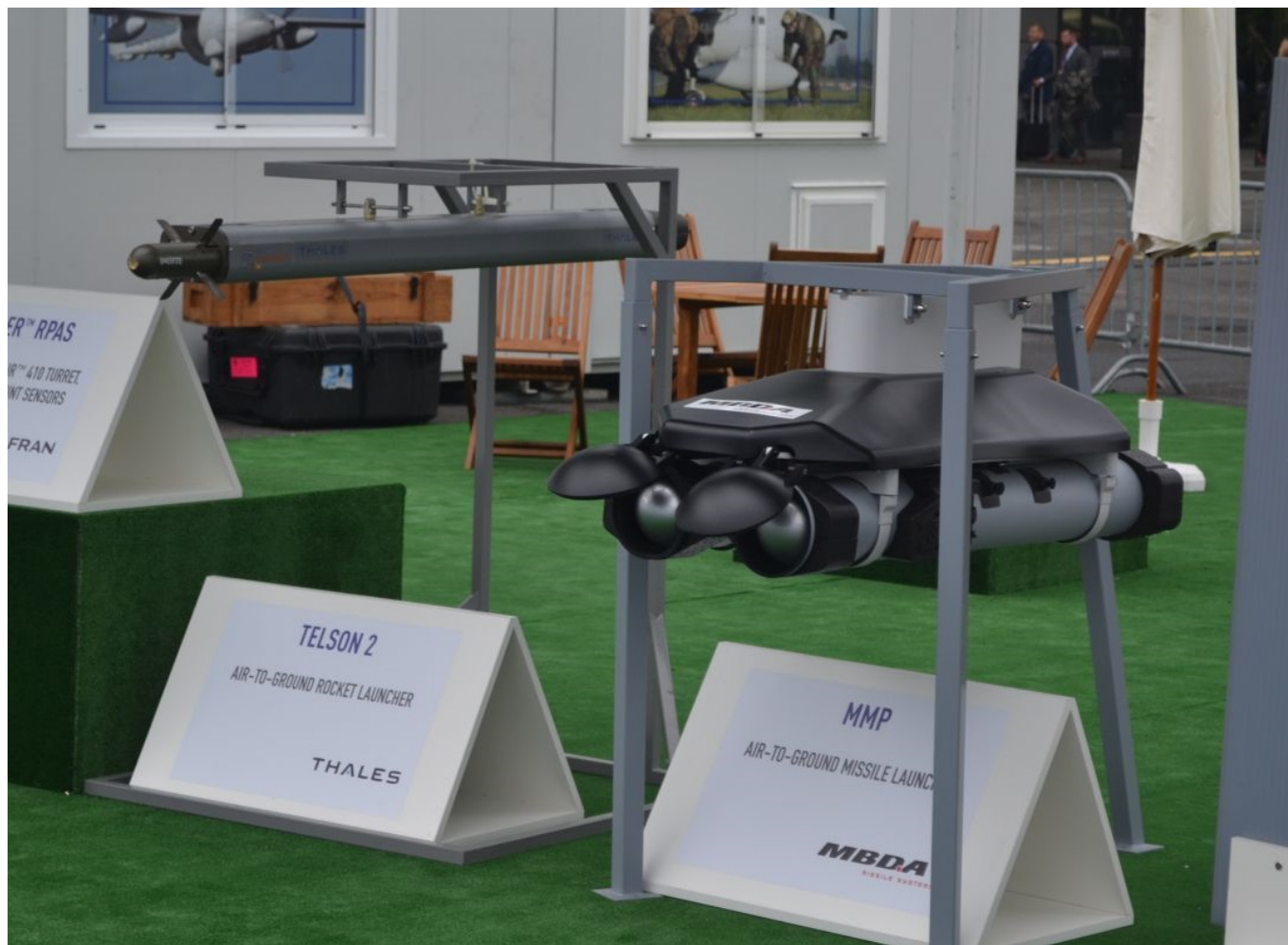
„Bojowe” zasobniki bezzałogowca Patroller” - od prawej: MMP koncernu MBDA z dwiema raketami „powietrze-ziemia” oraz TELSON 2 koncernu Thales z dwiema raketami naprowadzanymi laserowo „powietrze-ziemia”. Fot. M.Dura
