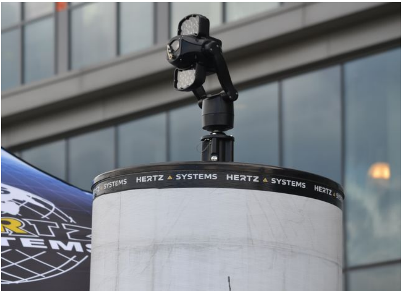
System „Jastrząb” wykorzystuje do wykrywania dronów radar w specjalnej kopule oraz znajdujący się ponad tą kopułą układ kamer – fot. M.Dura
