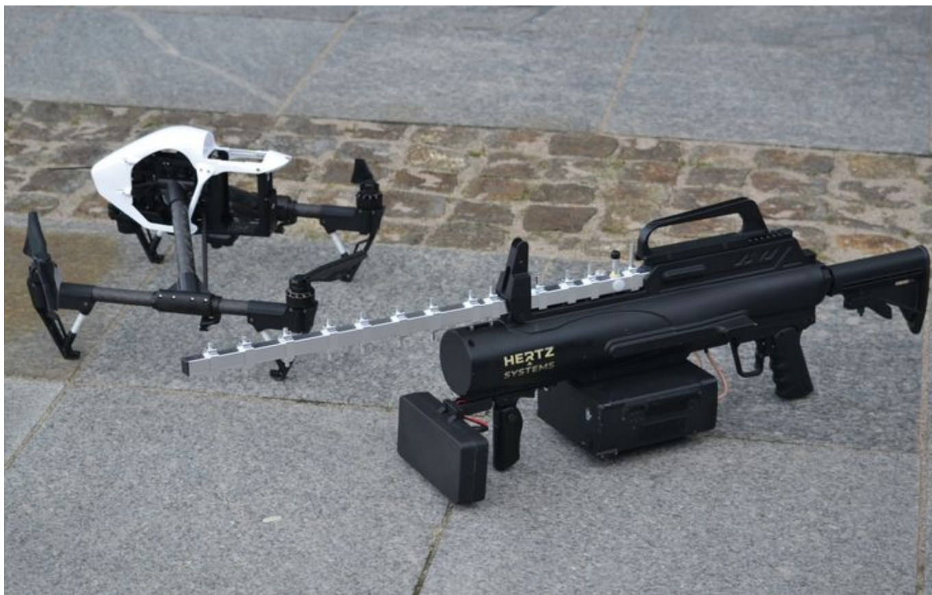
Neutralizator systemu „Jastrząb” i dron uszkodzony po wymuszonym lądowaniu (urwane śmigła w dwóch rotorach) – fot. M.Dura
