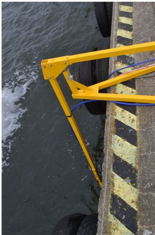
System opuszczania sonaru do wykrywania płetwonurków OBR CTM jest bardzo prosty w użyciu – fot. M.Dura
