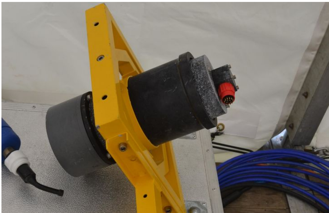
Sonar wykrywania płetwonurków opracowany przez OBR CTM - fot. M.Dura
