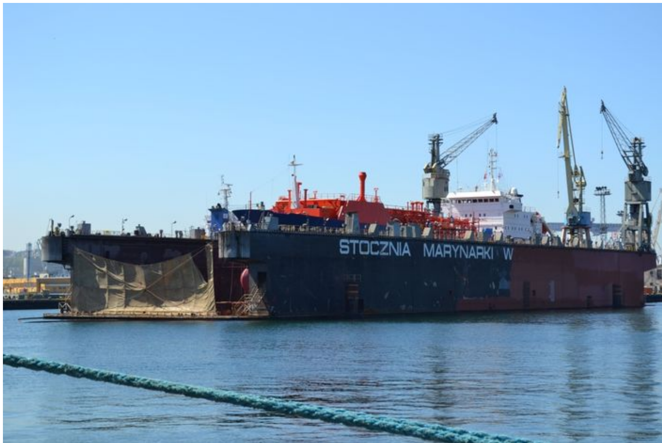
Stocznia Marynarki Wojennej jest również właścicielem doku pływającego o wyporności 8000 ton, długości 150 m i szerokości 27 metrów - fot. M.Dura
