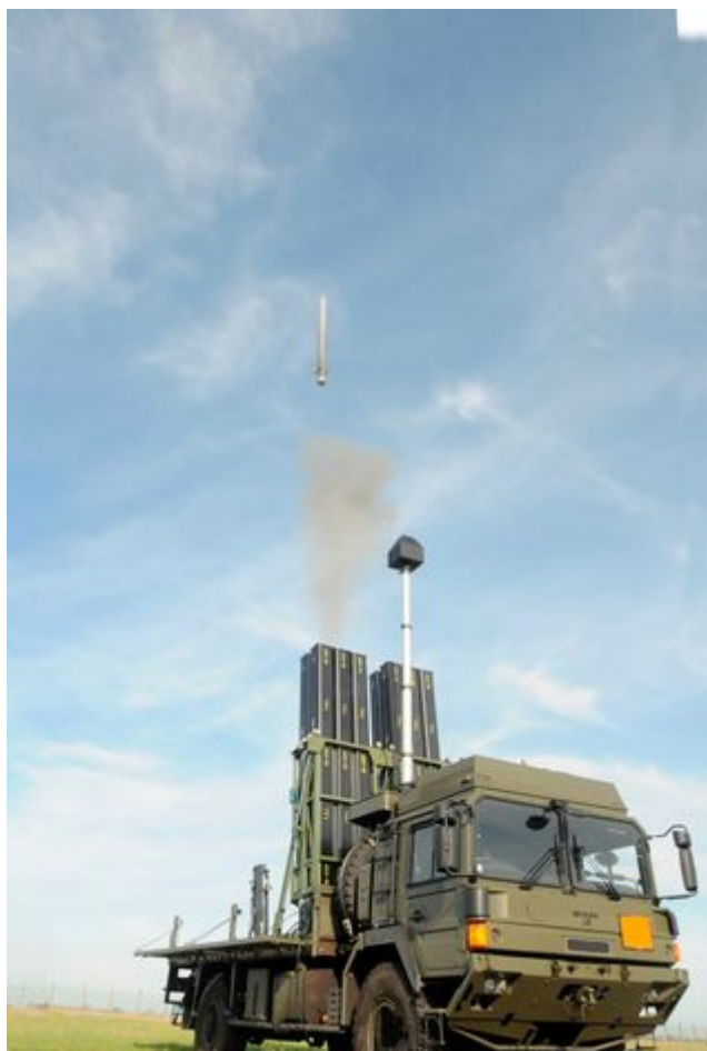
Zaletą rakiety CAMM jest „miękki” start, w którym silniki są odpalane dopiero w momencie startu rakiety. Fot. MBDA
