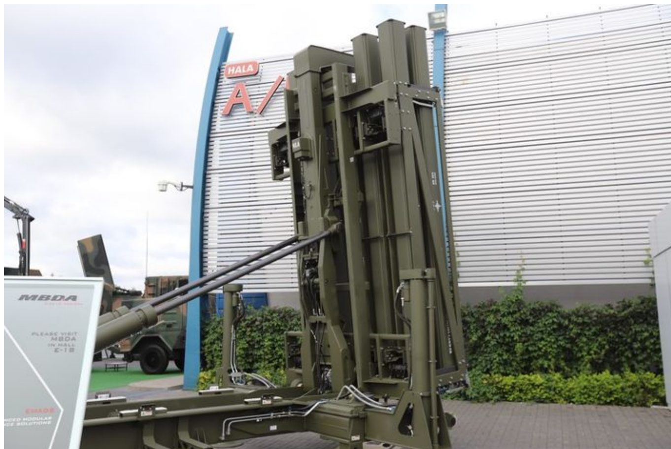
Rakiety CAMM są instalowane w lekkich i kompaktowych kontenerach co ułatwia ich montaż na nawet niewielkich pojazdach. Fot. M.Dura
