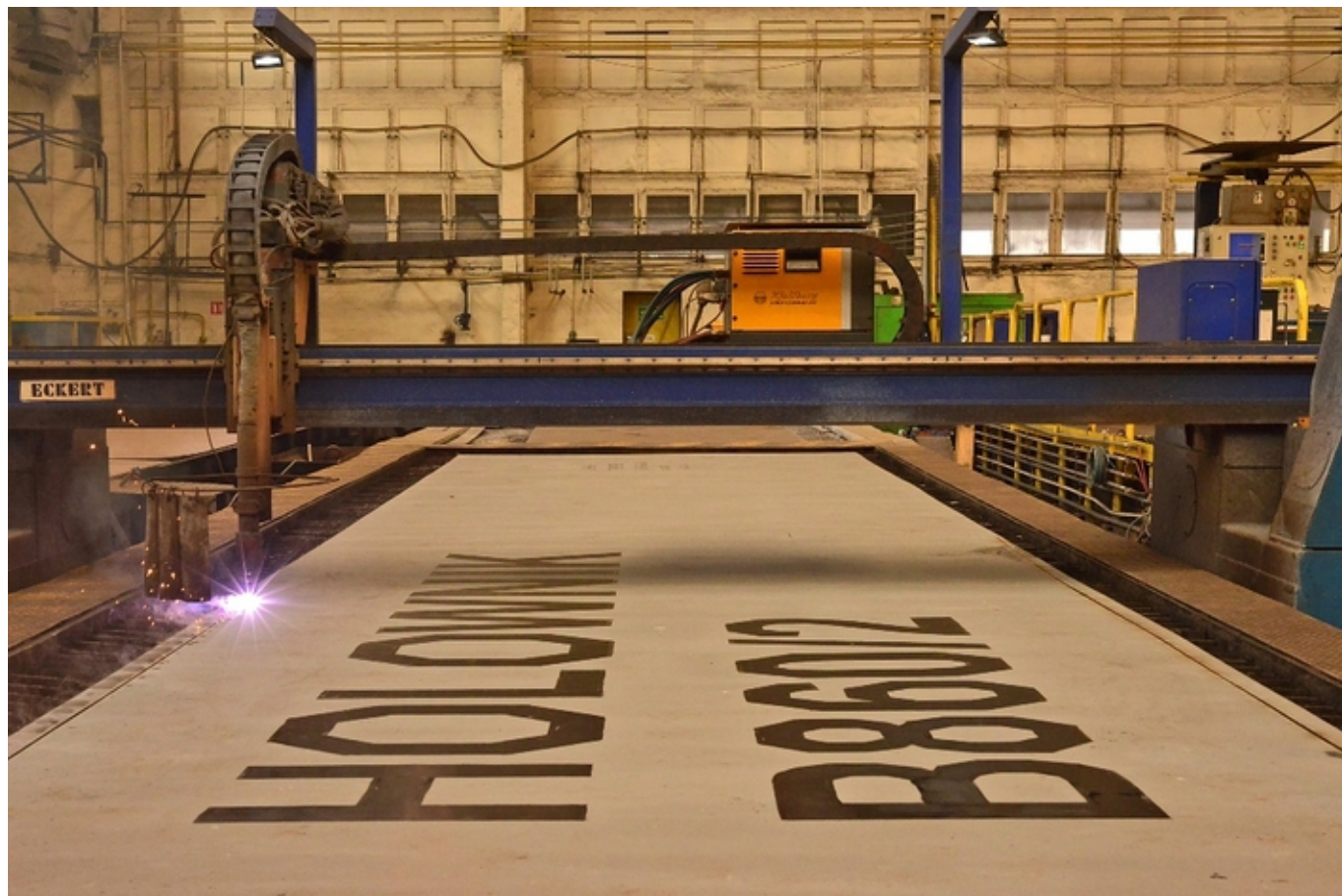
Cięcie blach drugiego holownika. Fot. Remontowa Shipbuilding.
