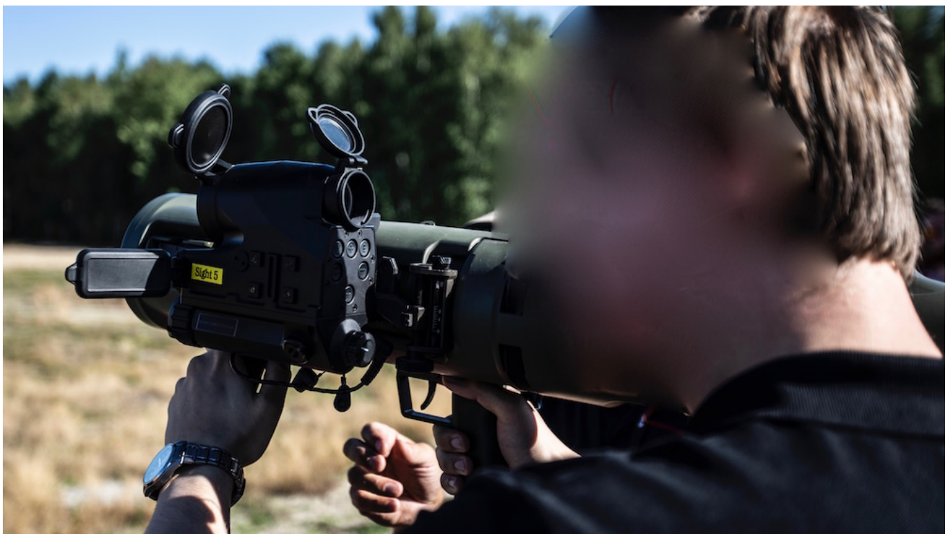
Celownik z komputerem balistycznym Aimpoint FCS13RE na wyrzutni Carl Gustaf. Fot. UMO
