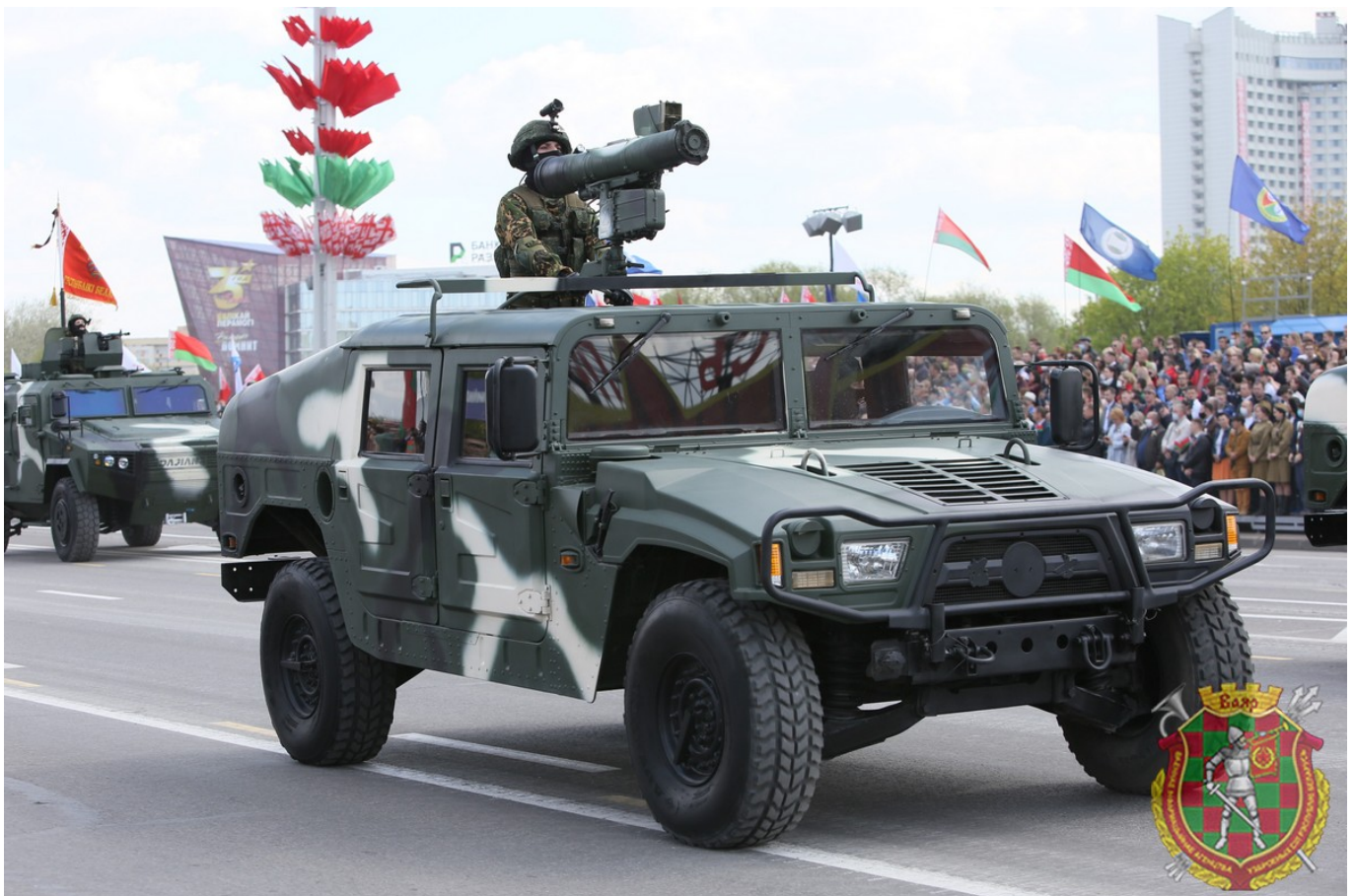
Pojazdy Bogatyr, mogą być uzbrojone w karabin maszynowe kalibru 7,62 mm (PKM) lub 12,7 mm (NSWT) lub wyrzutnię ppk 9K111-1 Konkurs). Fot. mil.by
