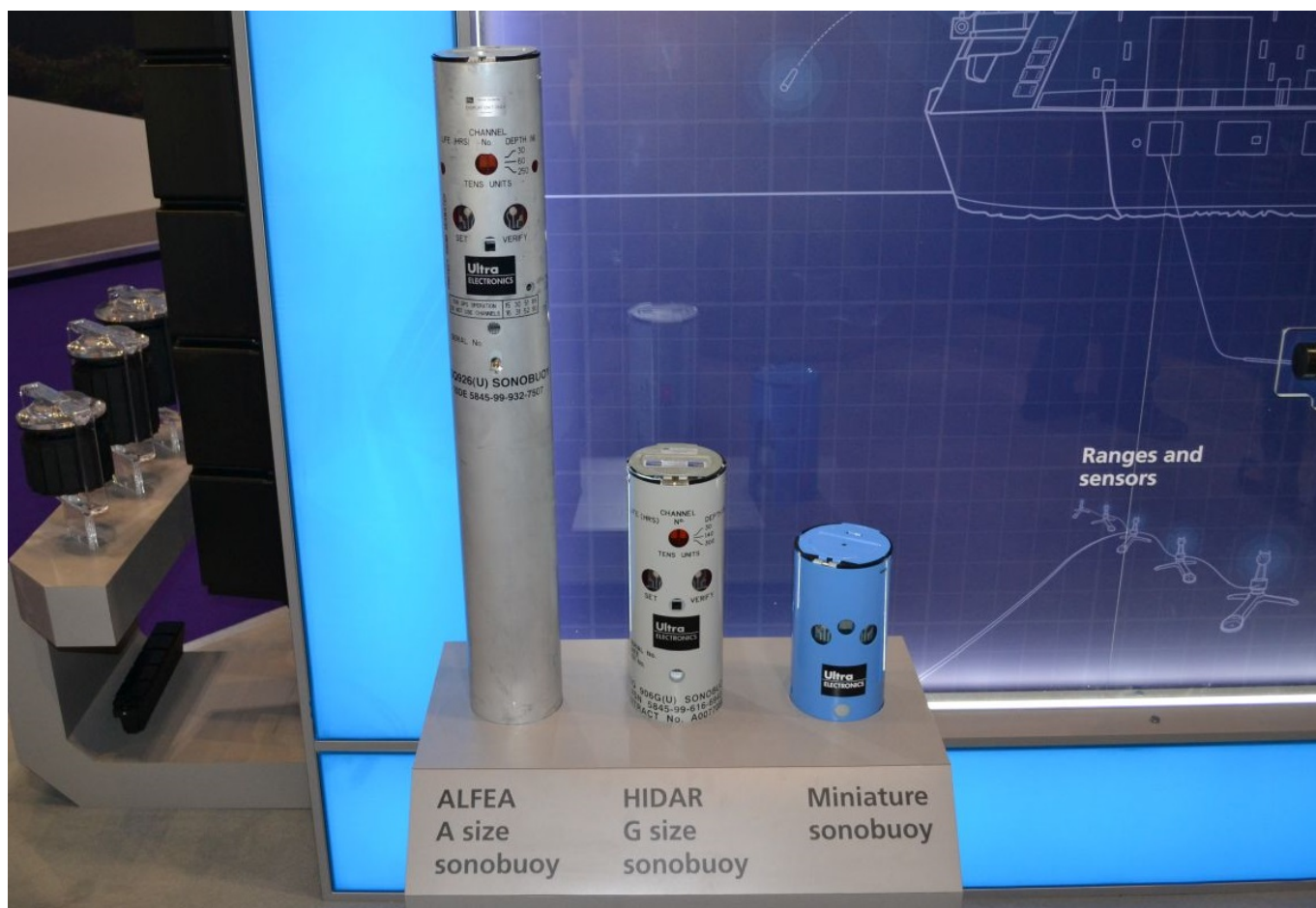
Firma Ultra jako jedyna proponuje małe pławy hydroakustyczne, które mogą być przenoszone przez drony. Fot. M.Dura
