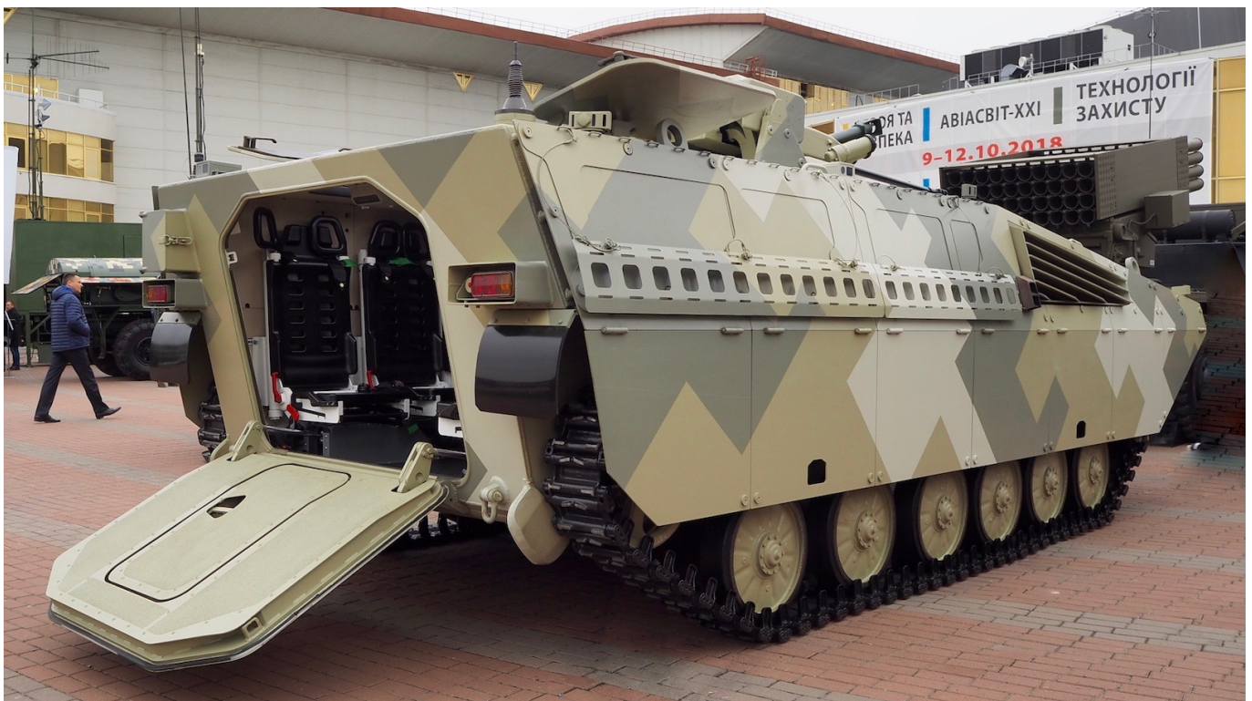
Większy przedział desantu z fotelami antywybuchowymi i tylną rampą Szakala. Fot. J.Sabak
