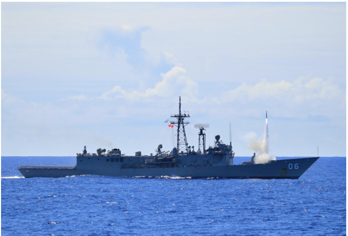
Nowe korwety fińskiej marynarki wojennej mają otrzymać odpalane pionowo rakiety przeciwlotnicze ESSM. Na zdjęciu strzelanie takich pocisków z australijskiej fregaty typu OHP/Adelaide HMAS Newcastle w 2010 r. Fot. Australian Defence Forces
